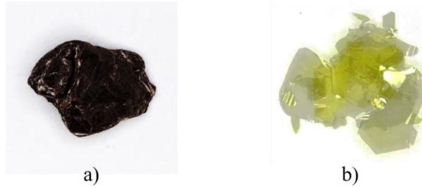
Şekil 3.14. a) GaSe kristali b) GaS kristali
