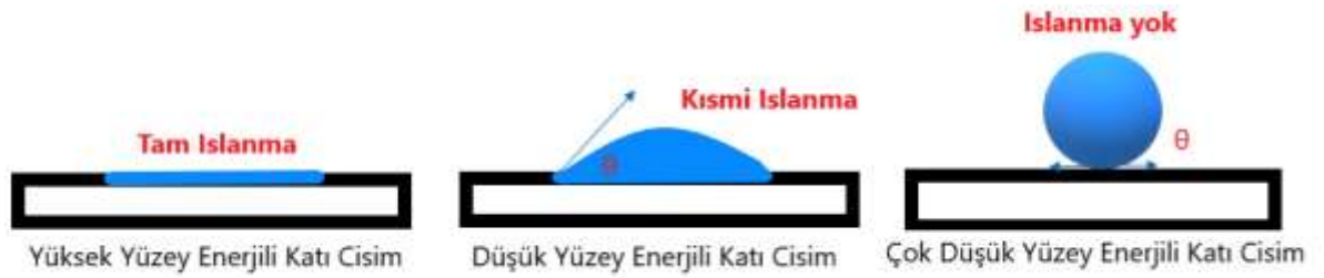
Şekil 2.5. Temas açısı, yüzey enerjisi ve ıslanabilirlik ilişkisi (Cansever 2016'dan adapte edilmiştir).
