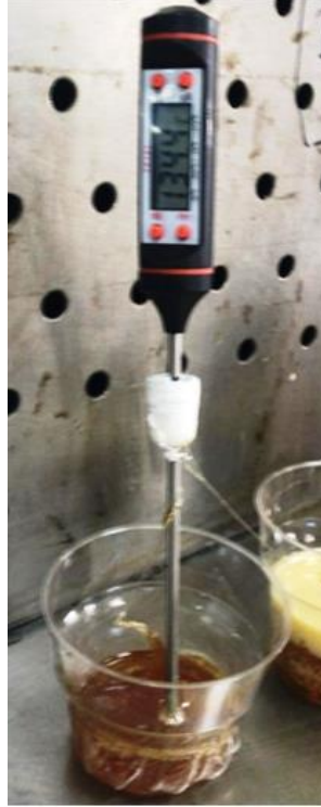
Şekil 3.6. Ekzotermik reaksiyonda sıcaklık ölçümü
