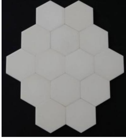
Şekil 2.8. Altıgen parçacıklar halinde alümina zırh plakaları (Hjbm.en.ecplaza, 2021)
