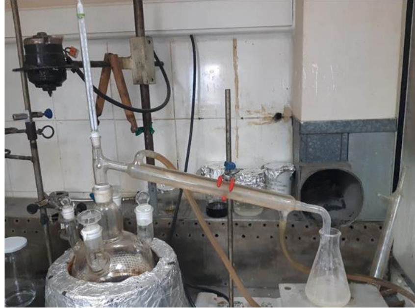
Şekil 3.2. Polyester Poliöl formülü için reaksiyon düzeni
