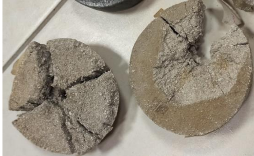
Şekil 4.9. Rijit numunelerde penetrasyona örnekleri
