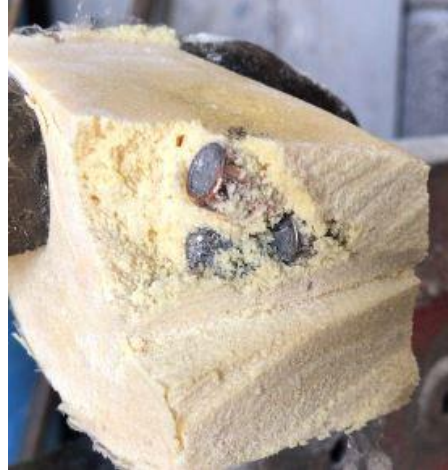
Şekil 5.2. Poliüretan – alümina kompozisyonunda 9 mm Parabellum mermi etkisi
