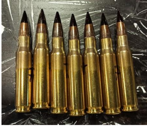
Şekil 3.44. Testler için üretilen iç çekirdek takviyeli fişekler
