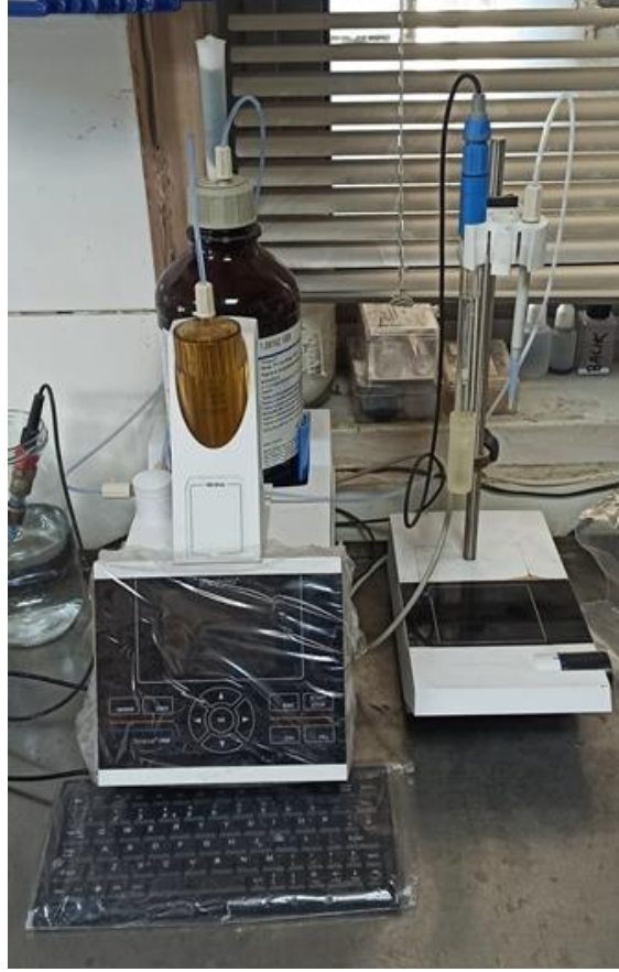
Şekil 3.5. OH Metre Titrasyon Cihazı ve Manyetik Karıştırıcı
