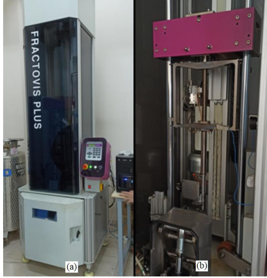
Şekil 3.31. Drop Tower Impact Test için (a) CEAST-Fractovis Plus 9350 cihazı ve
