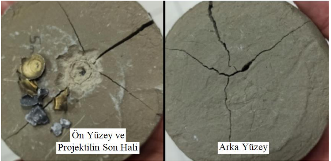
Şekil 4.12. Nihai “poliüretan-seramik tozu” kompozisyonunu oluşturan numune görseli
