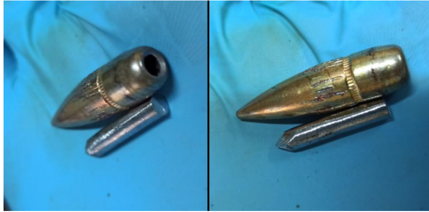
Şekil 3.43. Hazırlanan mermi çekirdekleri ve iç mermi çekirdekleri
