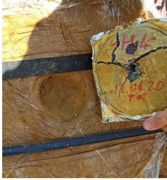
Şekil 4.32. Deneyler için üretilen zırh delici mermiye karşı başarılı olan kompozisyon
