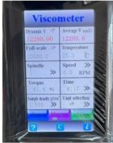
Şekil 5.5. Deneylerde kullanılan poliölün viskozite ölçümü
