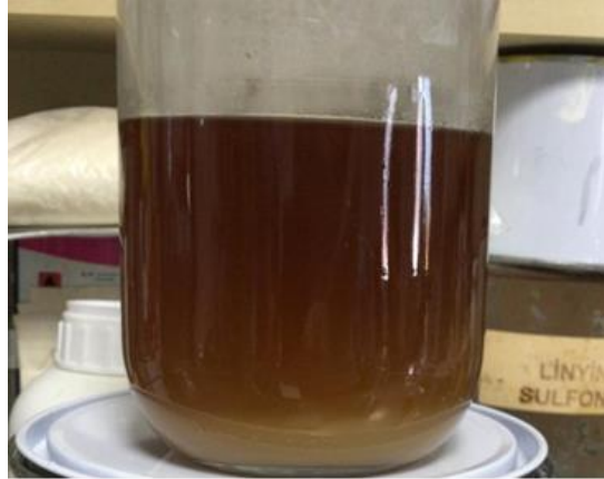
Şekil 3.3. Çökme neticesinde heterojen yapı sergileyen başarısız bir formül
