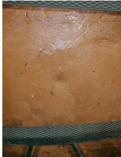
Şekil 4.35. Resmi balistik testlerde kullanılan sabitleme düzeneği ve arka yüz malzemesi
