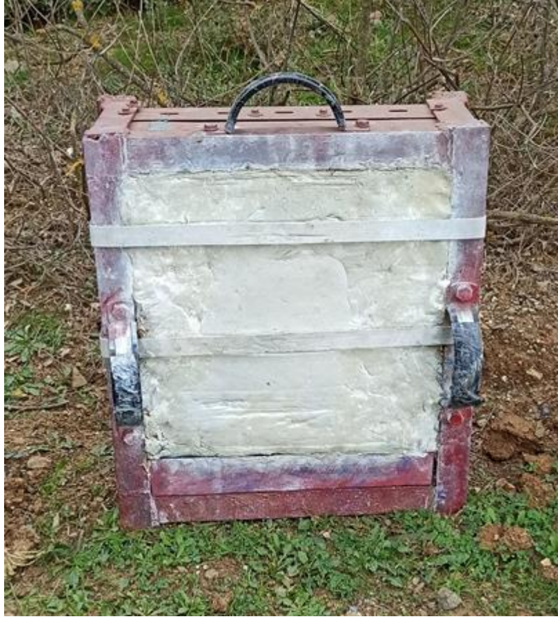
Şekil 3.25. 40 cm x 50 cm boyutlarında hedef tutucu düzenek
