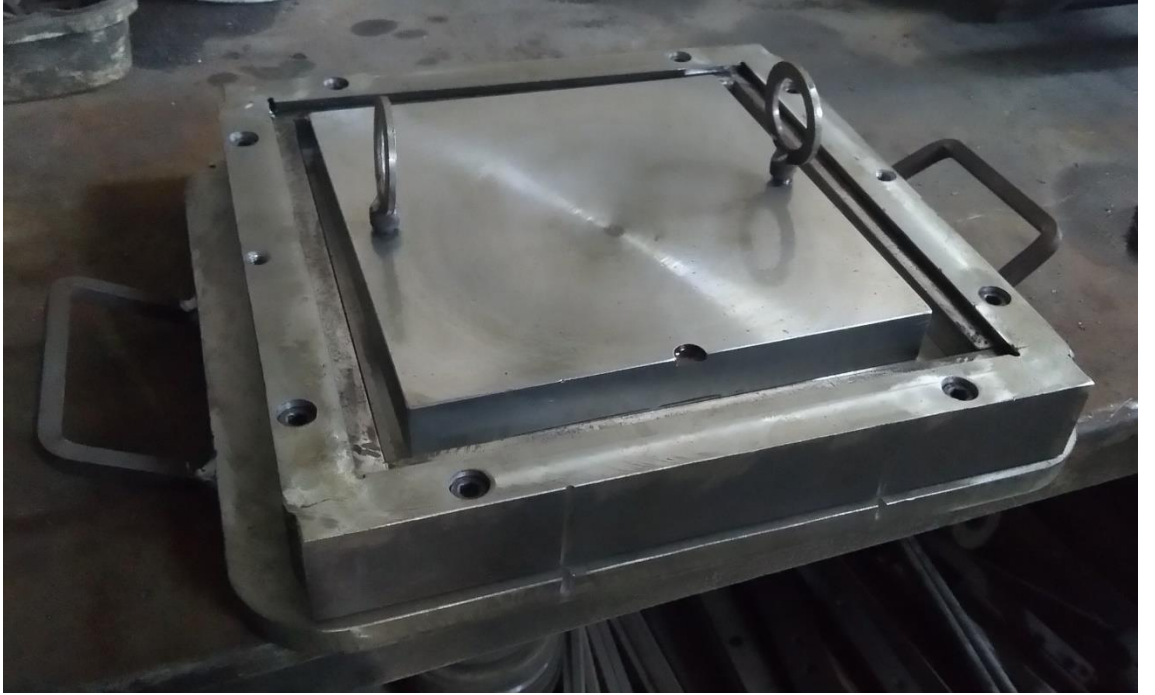
Şekil 3.48. 30 x 30 cm ölçülerinde numuneler üretmek için hazırlanan çelik kalıp
