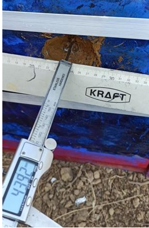
Şekil 4.29. Slug merminin yarattığı arka yüz deformasyonu ve ölçümü
