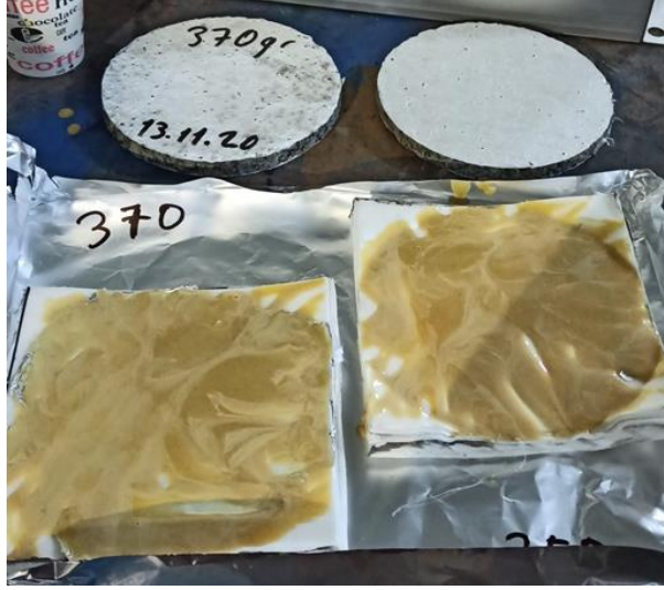
Şekil 4.30. Seramik katkı yüzey ve elyaf yüzeyin birleştirilmesi
