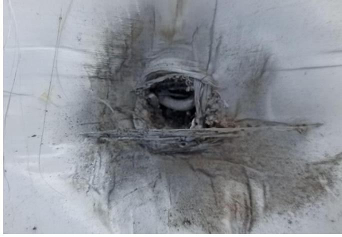
Şekil 5.3. Üretilen numunelerde, zırh delici merminin çelik iç çekirdeğinin yarattığı deformasyon
