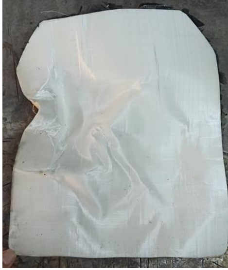
Şekil 5.4. Piyasadan temin edilen ve bir çok kere atışa tabi tutulan bor karbür plakanın elyaf arka bölümü
