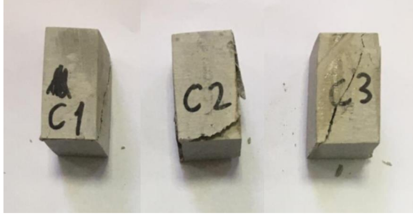
Şekil 4.4. Seramik tozu katkılı numunelerin basma deformasyonu
