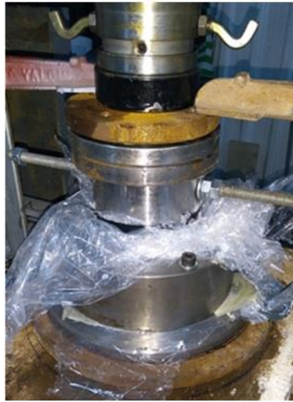
Şekil 3.23. Basınç altında bekletilen kalıp içerisinde formül düzeneği
