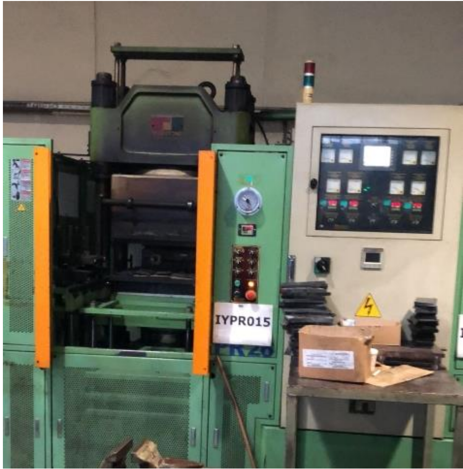
Şekil 3.49. 30 x 30 cm ebatlarında numunelerin üretilmesinde kullanılan hidrolik pres
