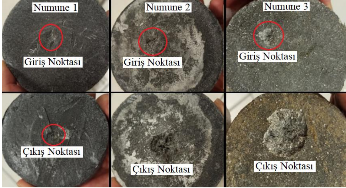
Şekil 4.10. Bor karbür yoğunluklu numunelerin atış sonrasında kendi kendine kapanan penetrasyona bölgeleri
