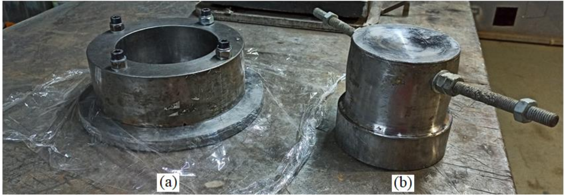
Şekil 3.20. 15 cm iç çaplı (a) dairesel kalıp ve (b) piston
