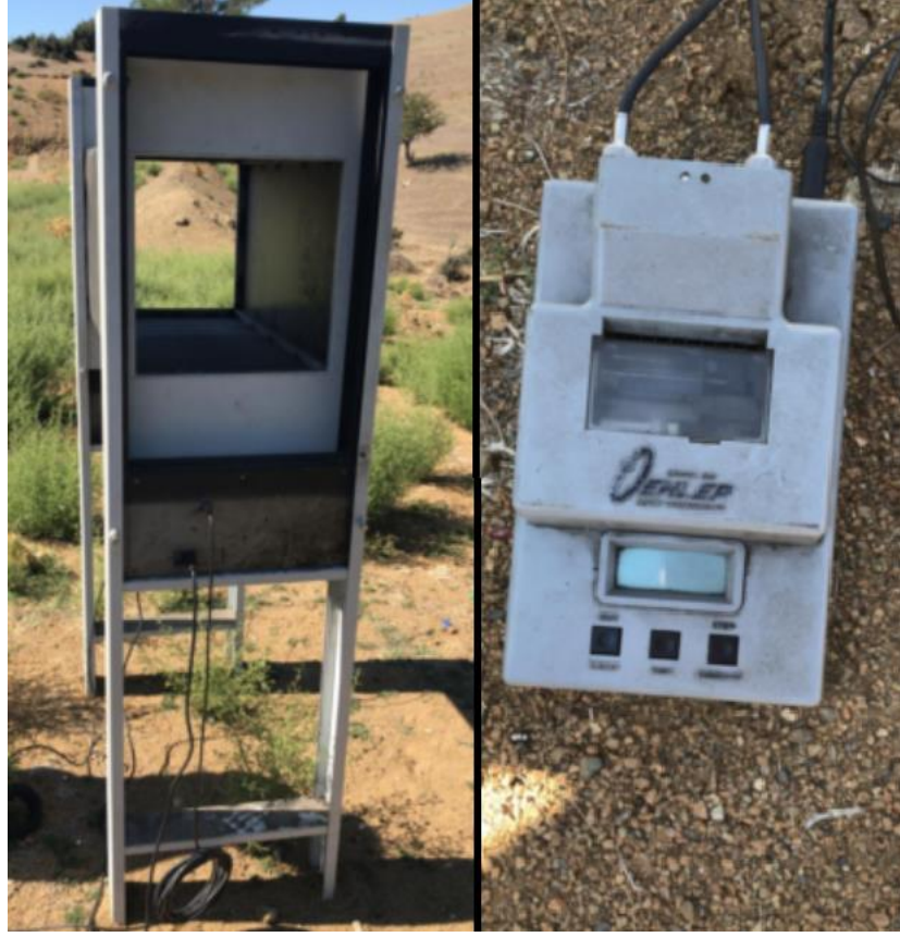
Şekil 3.39. Av tüfeği fişekleri için hız ölçüm cihazı
