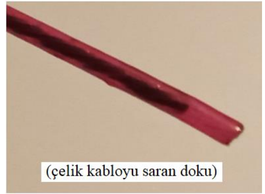
Şekil 2.4. Esnek yapılı poliüretan örnekleri
