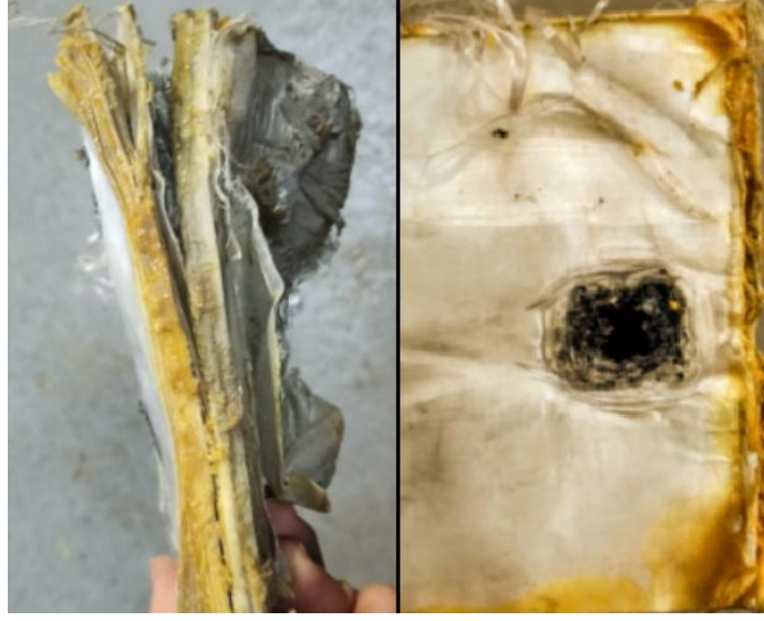
Şekil 4.28. “Slug” olarak isimlendirilen 12 kalibre tek kurşunun numune kenar noktasındaki etkisi
