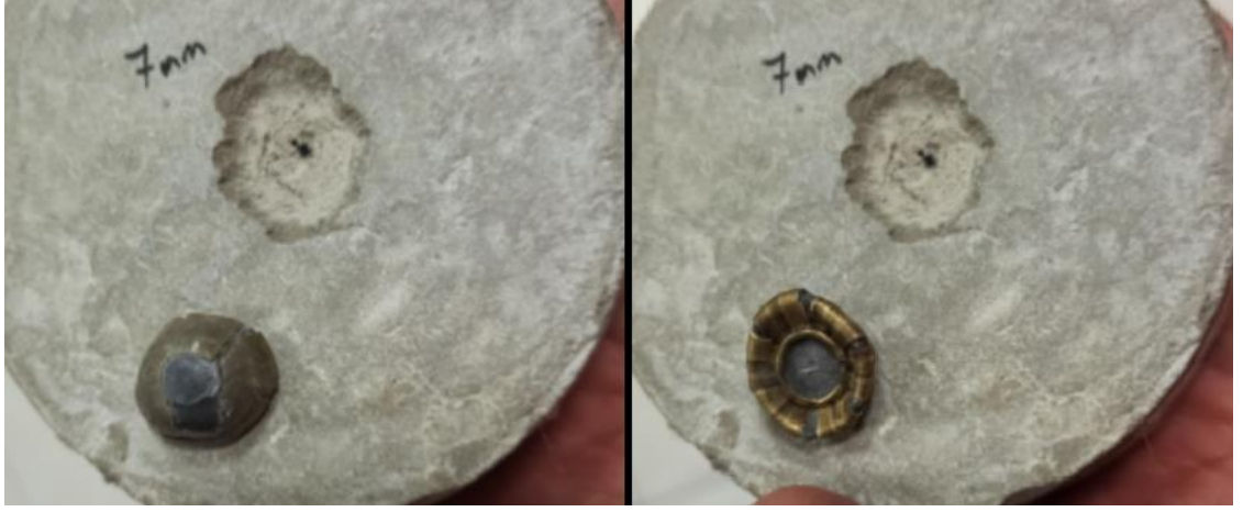
Şekil 4.11. 7 mm deformasyona sahip numune ve kullanılan mühimmat çekirdeği
