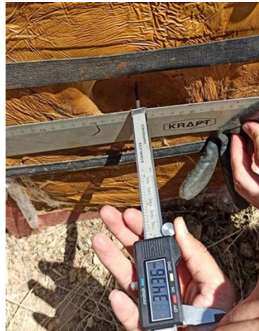
Şekil 4.33. H4 kompoziti için arka yüz deformasyon ölçümü
