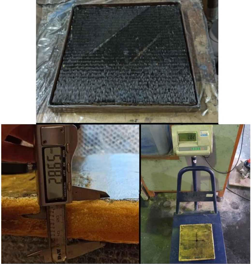
Şekil 4.39. NIJ IV seviyesinde başarılı olan numunesine ait görseller
