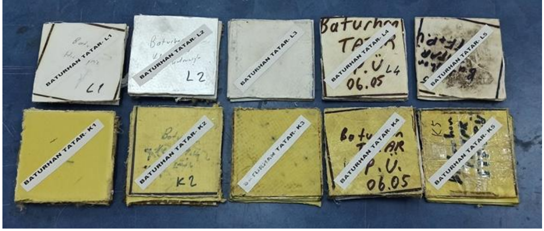
Şekil 3.34. Düşen Ağırlık Darbe Testi için elyaf numuneler
