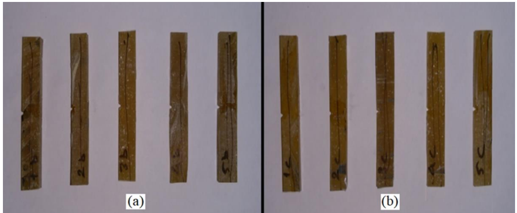
Şekil 3.13. Tek Çentikli Charpy Darbe Testi için hazırlanmış poliüretan numuneleri [(a) L-200527-1 poliöl formülünden (b) L-200929-1 formülünden elde edilmiştir]
