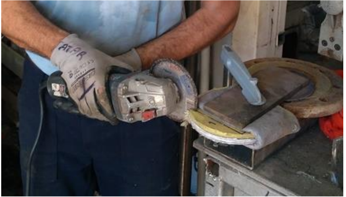
Şekil 3.33. Numunelerin mengene düzeneğinde spiral makinesiyle kesilmesi
