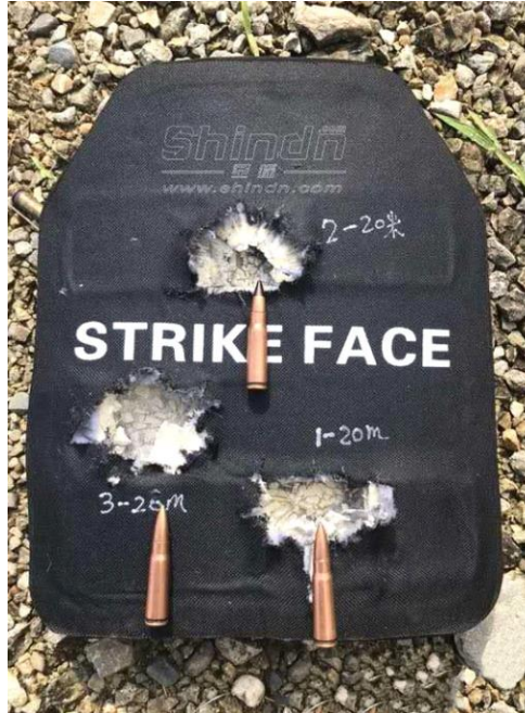
Şekil 2.9. Balistik darbeler sonrası Alümina zırh plakası örneği (Thickened type alumina, 2021)
