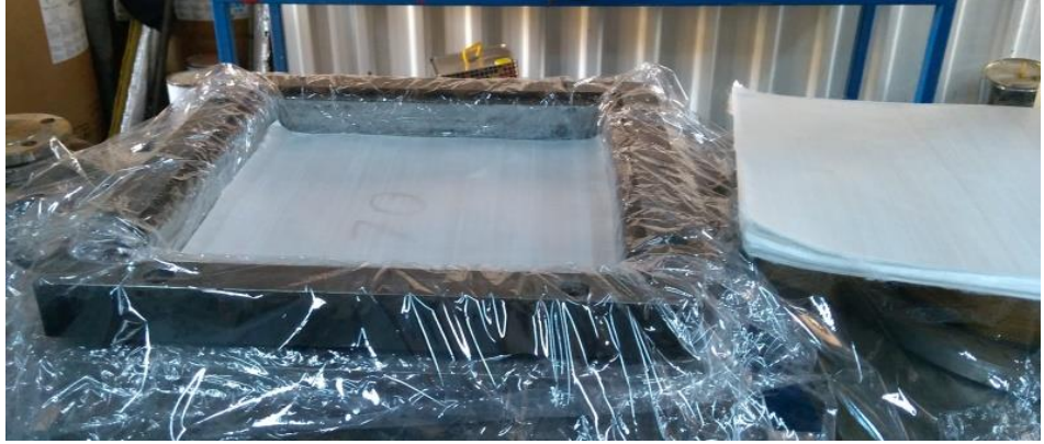
Şekil 4.34. Poliüretan uygulamasından önce kalıp ve elyafların hazırlanması
