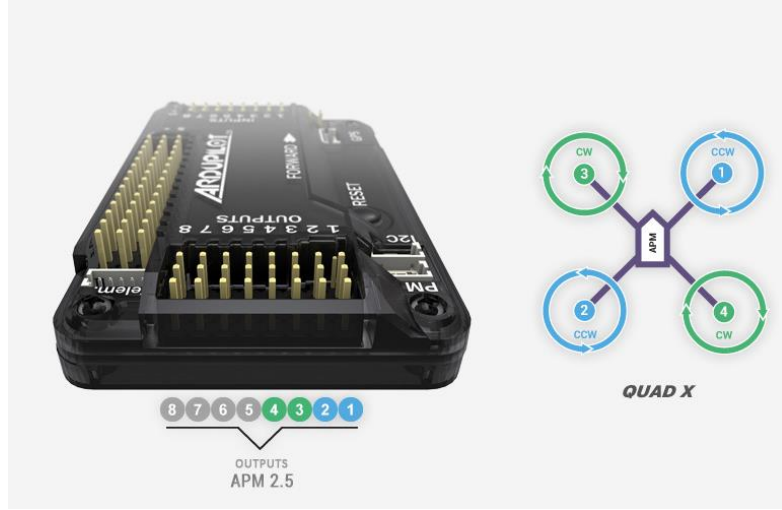
Şekil 5.2. APM de motor dizilimi ve bağlantısı
