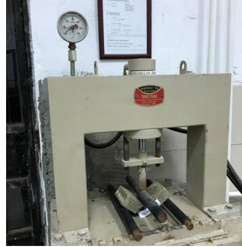
Şekil 3.13. Trakya Üniversitesi Mimarlık Fakültesi Yapı Malzemesi Kliniği’nde gerçekleştirilen eğilme momenti dayanımı deneyi, numuneler ve kırılma anındaki kuvvet
