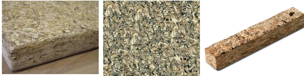
Şekil 1.4. Atık ayçiçeği çekirdeği tohumu kabuğu liflerinden üretilen alternatif ahşap yapı malzemesi ( www.madehow.com/Volume-5/Sunflower-Seed.html )
