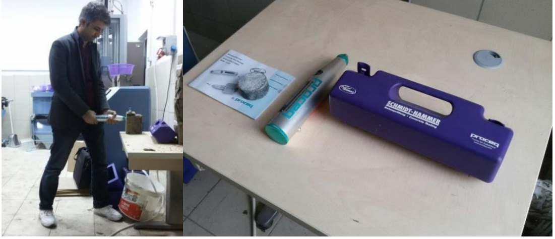
Şekil 3.14. Trakya Üniversitesi Mimarlık Fakültesi Yapı Malzemesi Kliniği'nde gerçekleştirilen Schmidt yüzey sertliği deneyi ve Schmidt çekici seti
