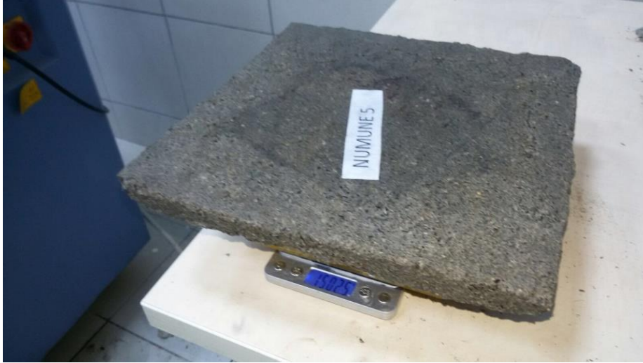
Şekil 3.10. Suya tam doygun halde alternatif ahşap numunelerin kütle ölçümü
