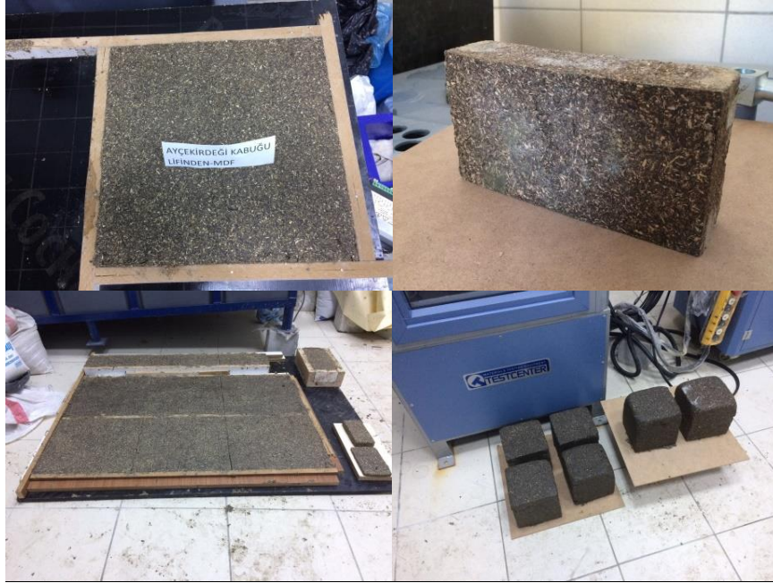
Şekil 3.6. Trakya Üniversitesi Mimarlık Fakültesi Yapı Malzemesi Kliniği’nde elle kalıplanarak hazırlanan alternatif ahşap numuneler
