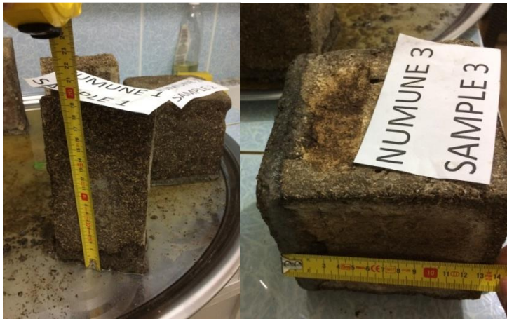
Şekil 3.8. Prizmatik ve küp numunelere ait kapiler yükseklik ölçümleri
