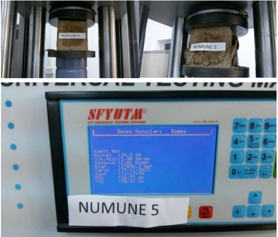
Şekil 3.11. Trakya Üniversitesi Mimarlık Fakültesi Yapı Malzemesi Kliniği’nde gerçekleştirilen basınç dayanımı deneyi ve 5 no’lu numunenin basınç dayanımı bulgusu
