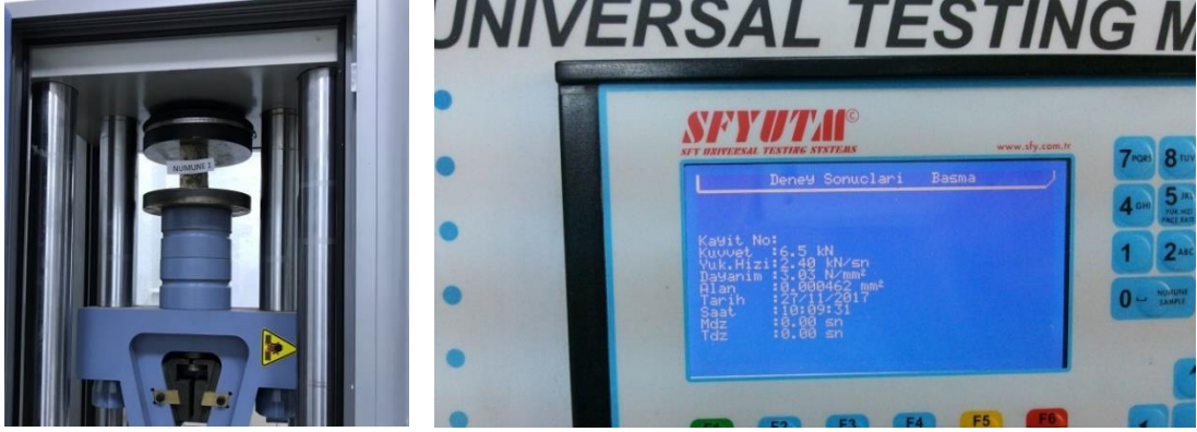
Şekil 3.12. Trakya Üniversitesi Mimarlık Fakültesi Yapı Malzemesi Kliniği’nde basınç dayanımı deneyi, numuneler ve kırılma anındaki kuvvet
