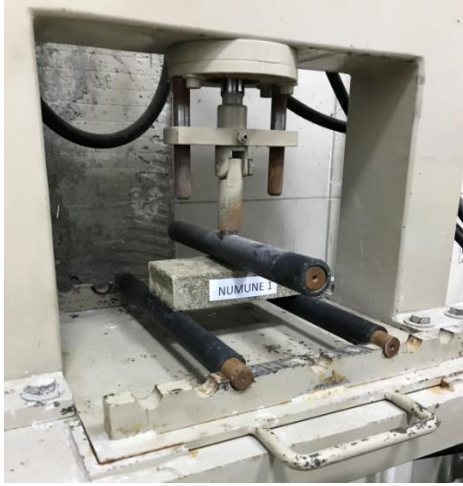
Şekil 3.13. Trakya Üniversitesi Mimarlık Fakültesi Yapı Malzemesi Kliniği’nde gerçekleştirilen eğilme momenti dayanımı deneyi, numuneler ve kırılma anındaki kuvvet
