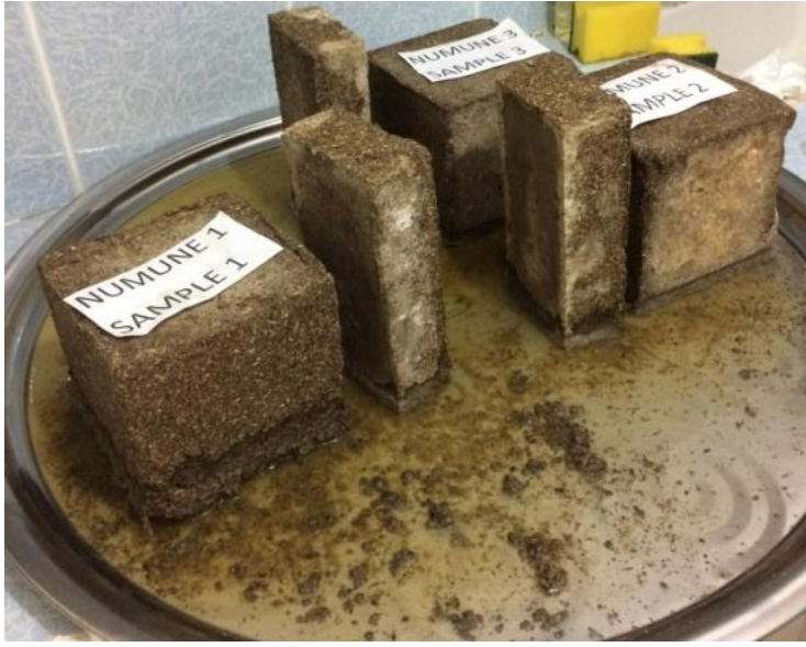
Şekil 3.7. Kapilarite deneyine ait başlangıç ve bitiş (24. Saat) fotoğrafları
