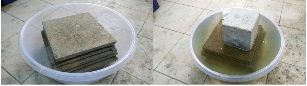
Şekil 3.9. Trakya Üniversitesi Mimarlık Fakültesi Yapı Malzemesi Kliniği'nde gerçekleştirilen su emme deneyi fotoğrafları
