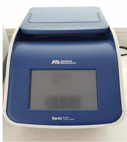
Şekil 3.7. Elde edilen RNA’ların cDNA’ lara çevrilmesinde kullanılan PCR cihazı.
