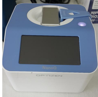
Şekil 3.6. RNA miktarlarının belirlenmesinde kullanılan nano spektrometre (NanoQ OPTIZEN).
