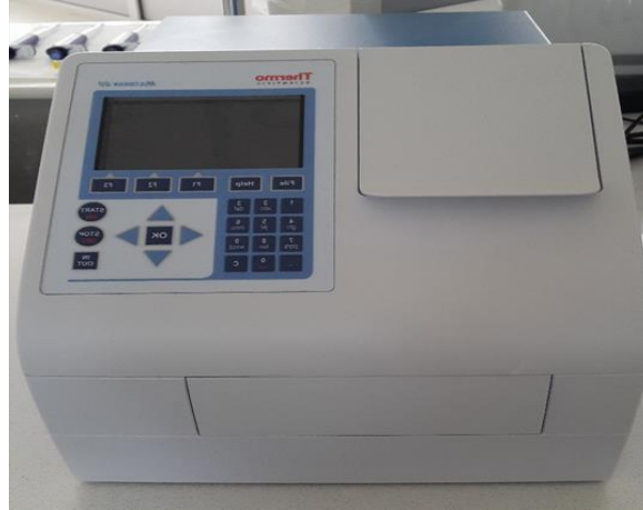
Şekil 3.5. MTT testinde kullanılan mikroploka okuyucu cihaz.
