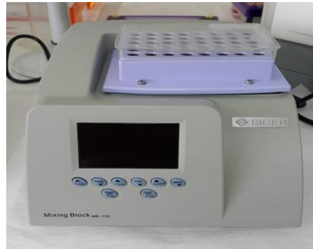
Şekil 3.3. Ekstre eldesinde kullanılan çalkalamalı, soğutuculu miks blok.
