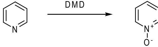
Şekil 2.13 Piridinin dimetildioksiran ile yükseltgenme reaksiyonu
