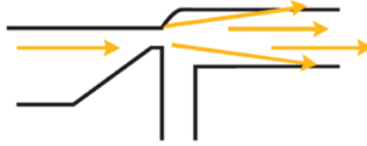
Şekil 3.14. Yüzey kalitesi için iyi akış görseli (NADCA, 2006)
