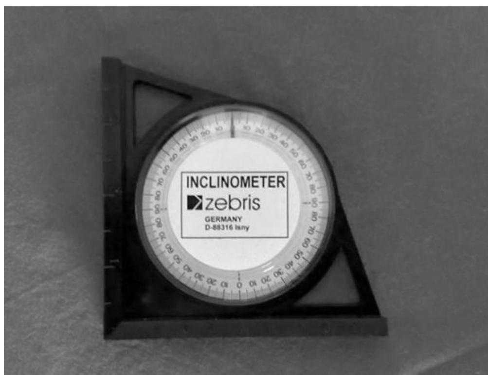
Resim 8. Manyetik inklinometre (açı ölçer)
