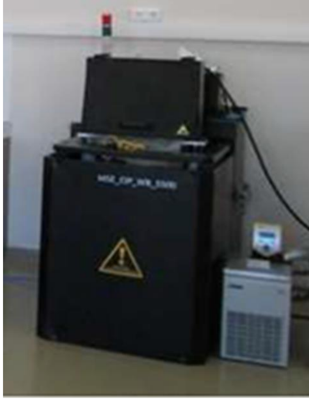
Şekil 3.1. Denemelerde kullanılan yüksek hidrostatik basınç düzeneği.
