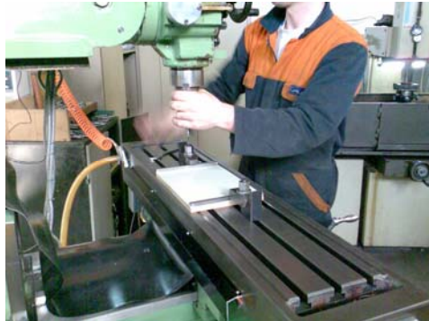
Şekil 3.6 Numunelerin talaşlı şekil verme yöntemiyle hazırlanması aşamasından bir görüntü
