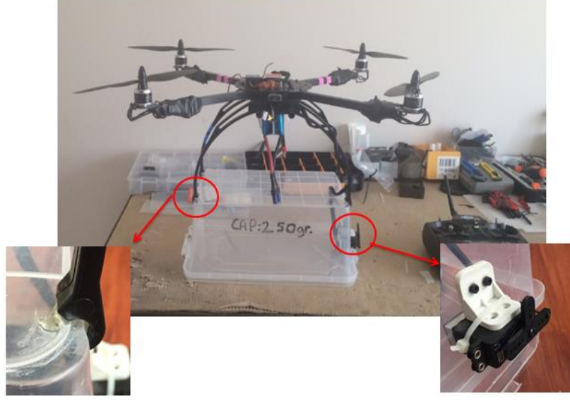
Şekil 9.14 Servo Motor ve Plastik Kap Montajı
