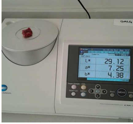
Şekil 3.14. Konica Minolta Cihazında Renk Ölçümü
