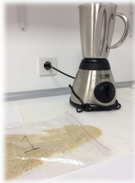
Şekil 3.6. Örneklerin kavuzlarının ayıklanıp öğütülmesi
