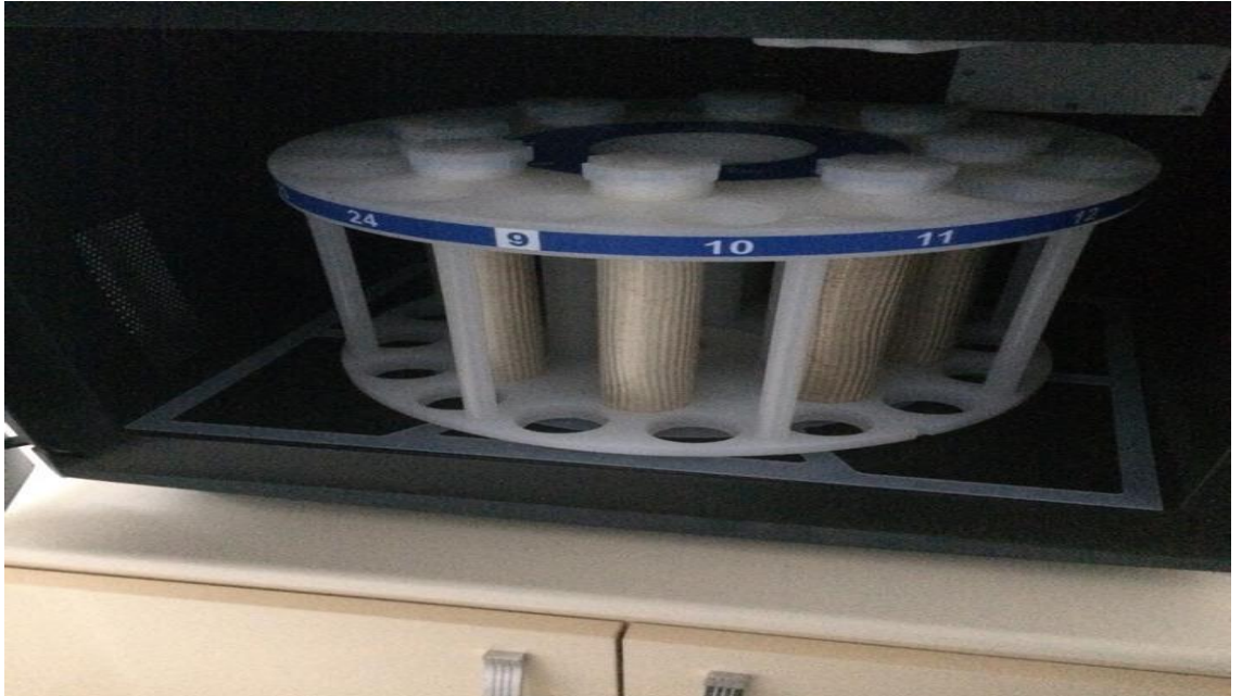
Şekil 4.1 CEM MARSXpress 5 Mikrodalga Çözme Sistemi
