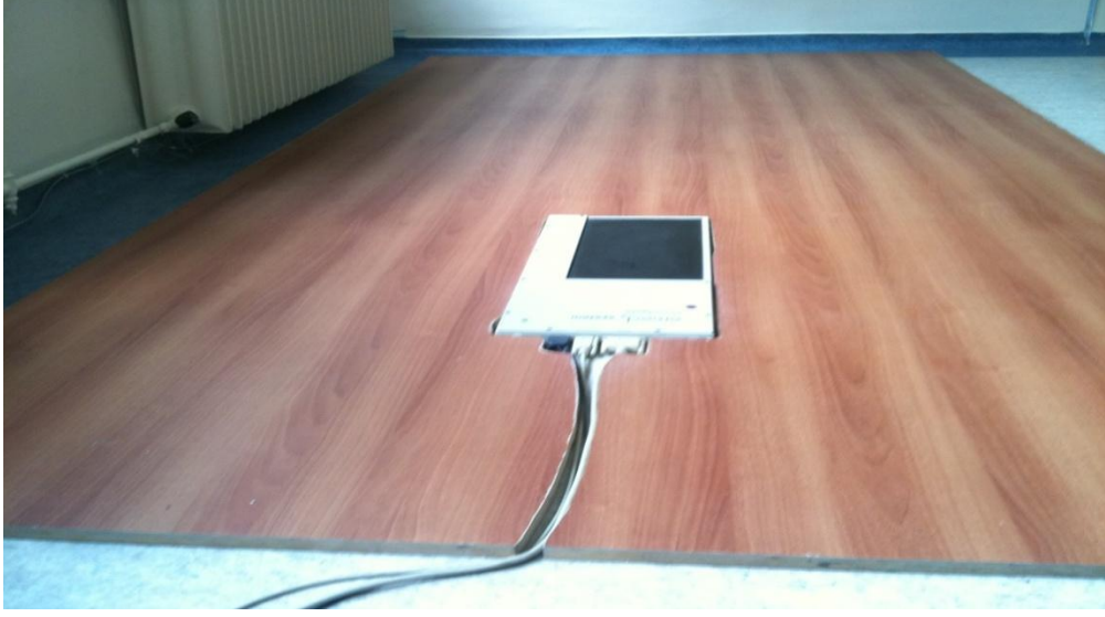
Şekil 2. Pedobarogram cihazının yürüme platformu ve basınç algılayıcı platformu
