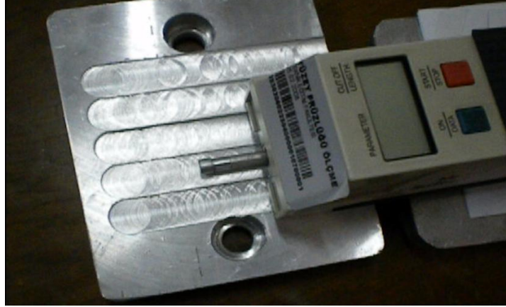
Şekil 4.3 Yüzey pürüzlüğü ölçüm aleti (Surftest 211)
