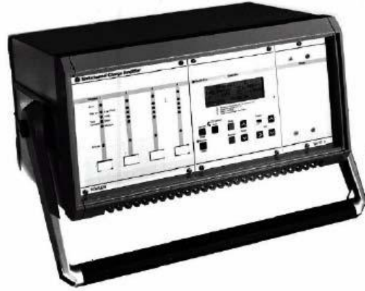
Şekil 4.5 KISTLER 5019b Tipi Yük Amplifikatörü
