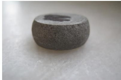
Şekil 6.6 Sıkıştırma döküm yöntemi ile üretilmiş %5 SiCp takviyeli kompozit numune
