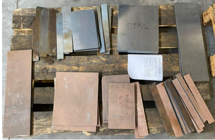
Şekil 3.1. S355J2C+N ve Hardox 450 plakalar.
