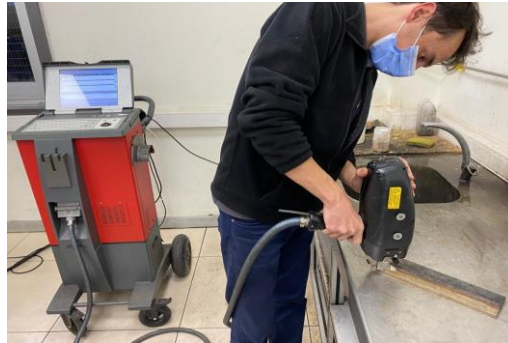
Şekil 3.21. Spektrometre cihazı ile ölçüm (Spectrotest TXC35 model portatif metal analiz cihazı).
