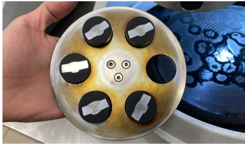
Şekil 3.22. Zımparalama ve parlatma işlemi, bakalite alınmış kaynak kesitleri.
