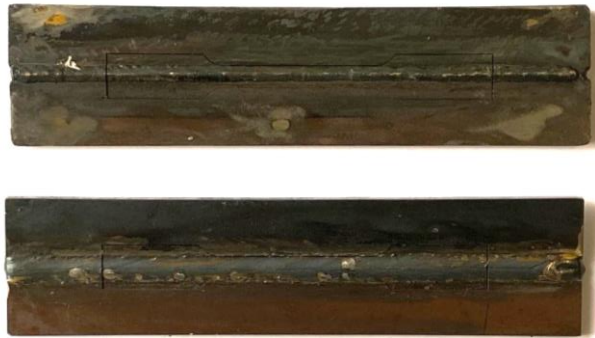
Şekil 3.11. Boyuna çekme ve eğme numunelerinin kesilmesi.
