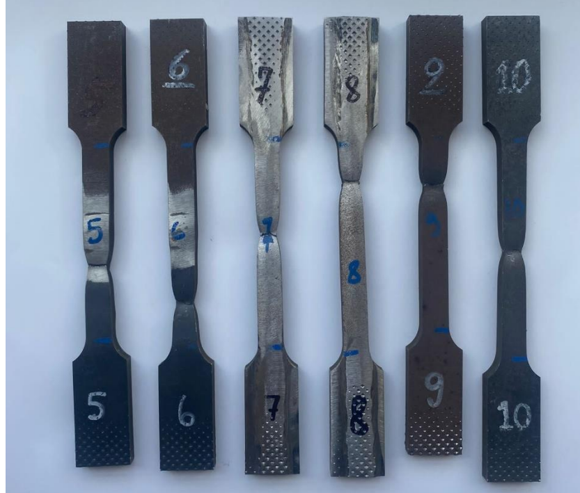
Şekil 4.3. Kaynaklı ve ana metallerin çekme testi numuneleri.
