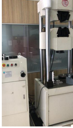
Şekil 3.19. Eğme deney cihazı (Zwick/Roell Z600 Universal Tester).
