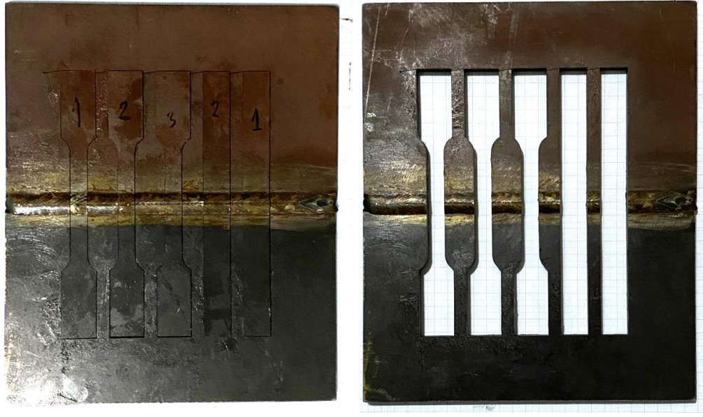
Şekil 3.9. Tel erezyon yöntemi ile kesilmiş enine eğme ve çekme numuneleri.
