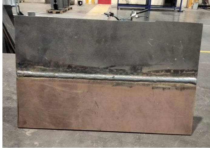
řekil 3.5. S355J2C+N ve Hardox 450 sacların SG3 elektrot ile kaynaklı birleřimi.
