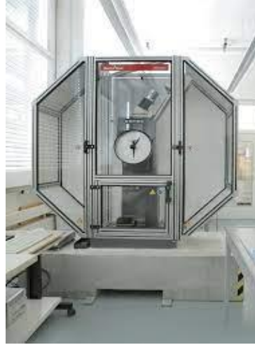
Şekil 3.20. Charpy deney cihazı (Zwick/Roell RKP 450).
