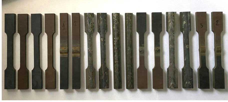
Şekil 3.12. Tel erzyon yöntemi ile kesilmiş eğme ve çekme numuneleri.
