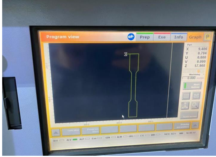
Şekil 3.7. Tel erzyon yöntemi ile numunelerin kesim arayüzü (Charmilles, Robofil 440).
