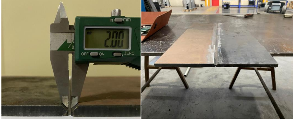
Şekil 3.2. Hardox 450 ve S355J2C+N çeliklerine V kaynak ağzı açma işlemi.
