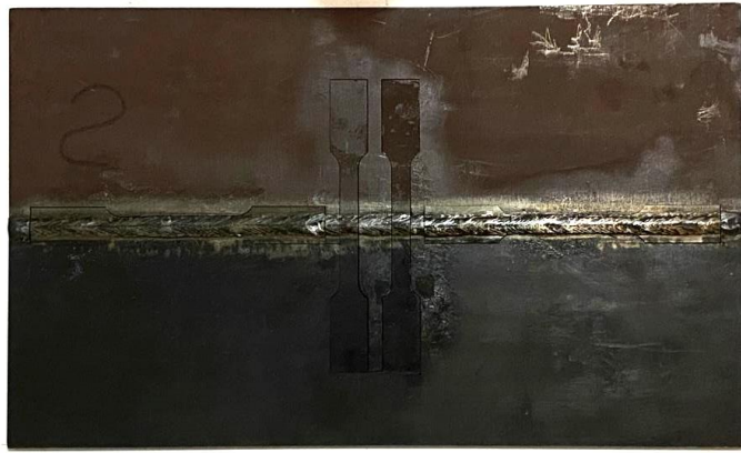
Şekil 3.10. Kaynaklı bir plakadan boyuna ve enine test plakalarının kesilmesi.
