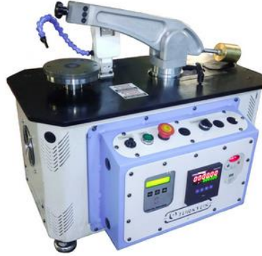
Şekil 3.26. Aşınma deney cihazı (UTS Tribometer T10).
