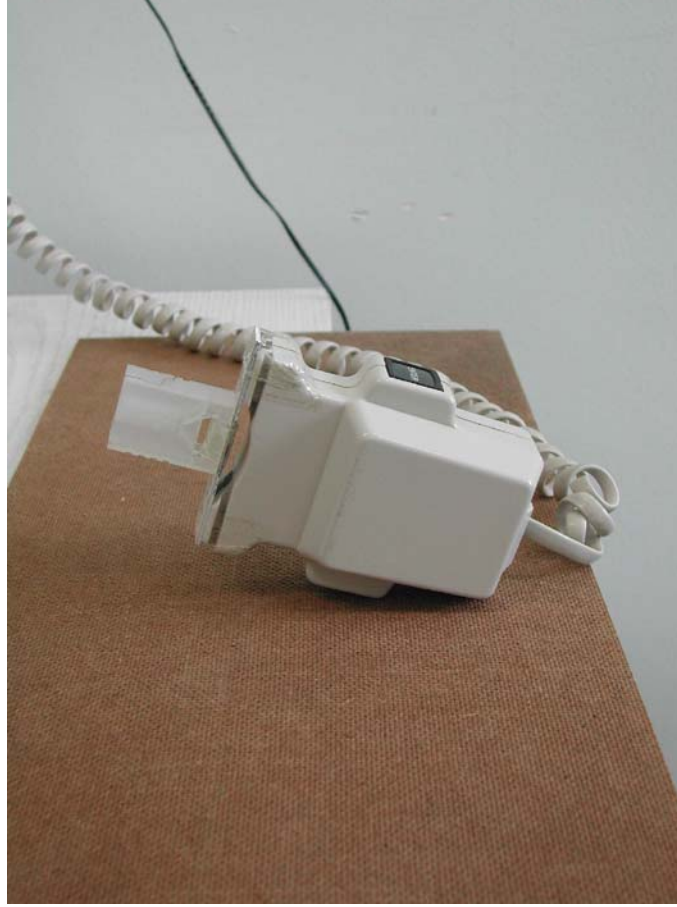
Resim 3. “Attachment” monte edilmiş EDI 320 inclinometre aletinin “probe” kısmı
