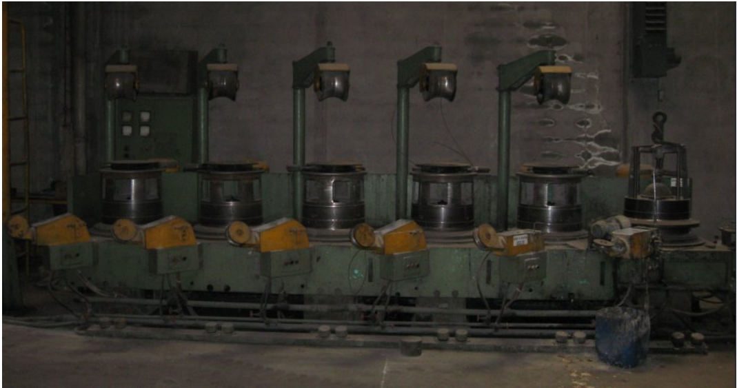
Şekil 1.7. Telin ardışık matrislerden geçişi
