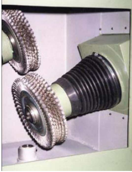
Şekil 1.4. Mekanik yüzey temizleme.
