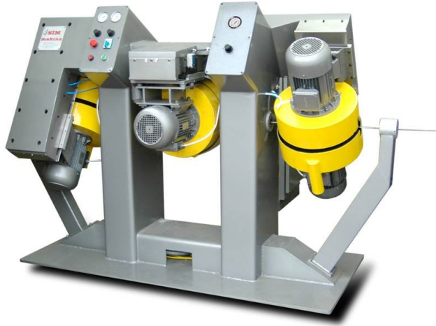
Şekil 3.3. Makaralarla mekanik yüzey hazırlama
