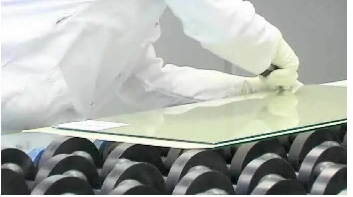
Fotoğraf 5.5.Dışarı taşan PVB'lerin kesilmesi
