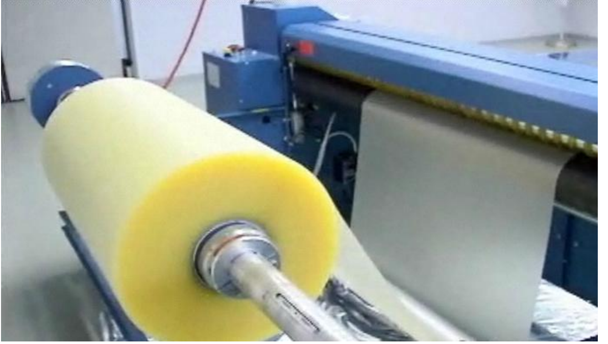
Fotoğraf 5.2.PVB rulo kesim işlemi
