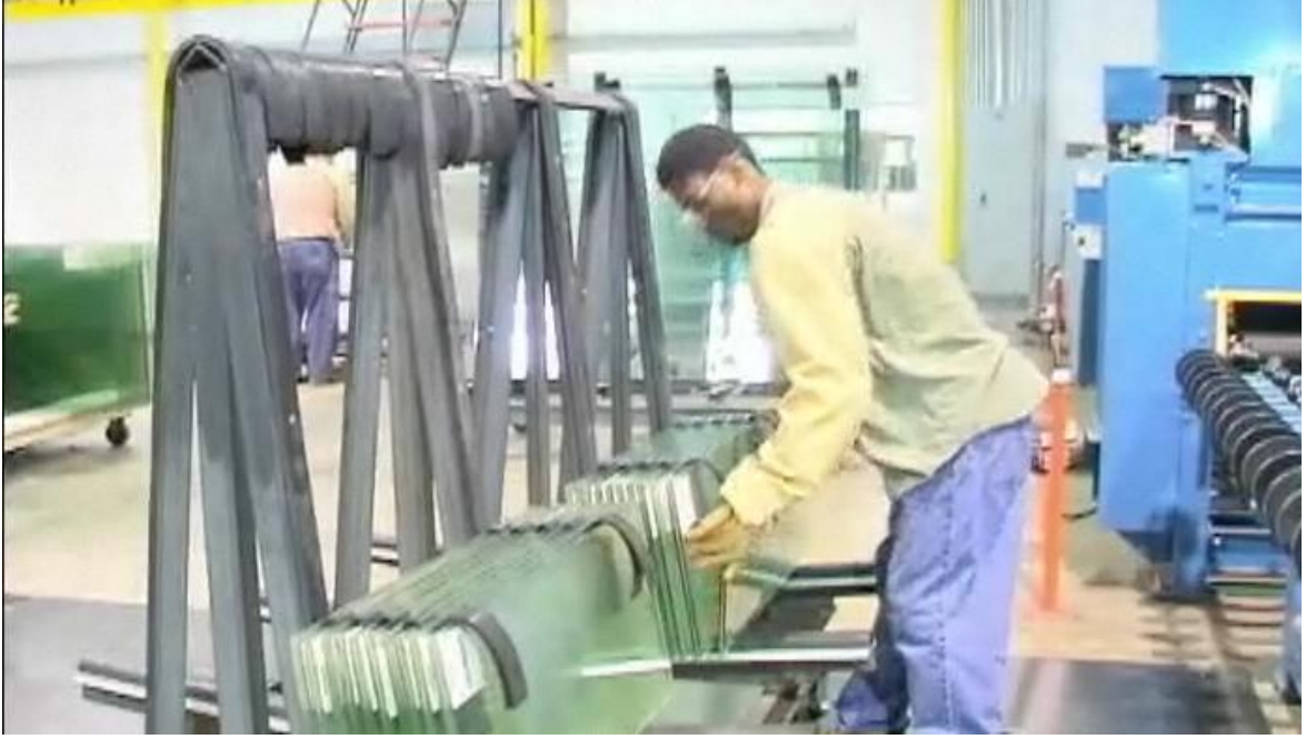
Fotoğraf 5.7. Lamine camların otoklav öncesi dizilişi
