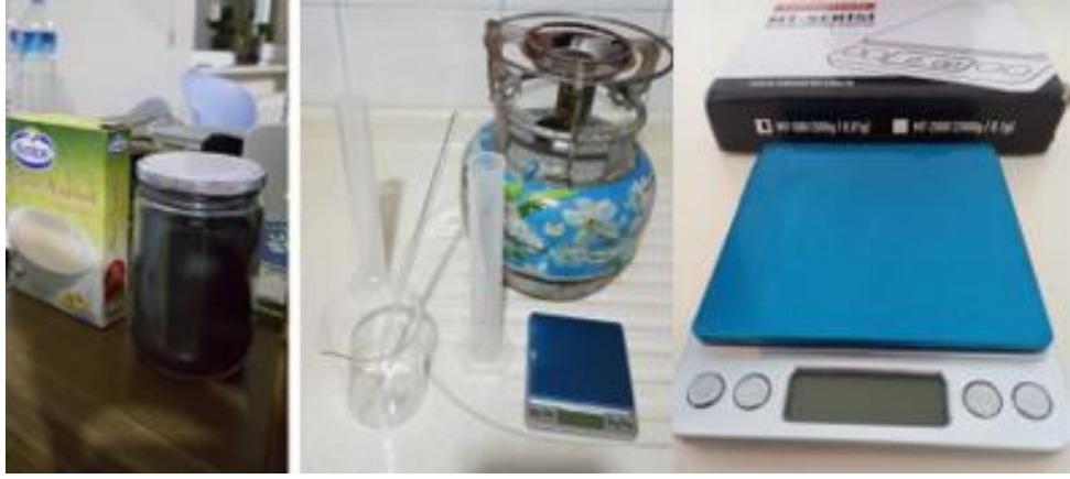
Şekil 4. 7. Kullanılan malzeme ve ekipmanların bazıları (mısır nişastası, grafite tozu, mezür, beher, piknik tüpü, hassas terazi).
