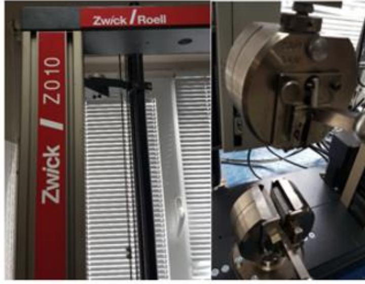
Şekil 4.15. Çekme testi cihazı zwick Z010 ProLine 10 kN.
