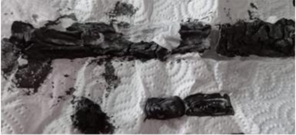
Şekil 4. 8. Grafit takviyeli numune ve baskı (grafit oranı %11,7).
