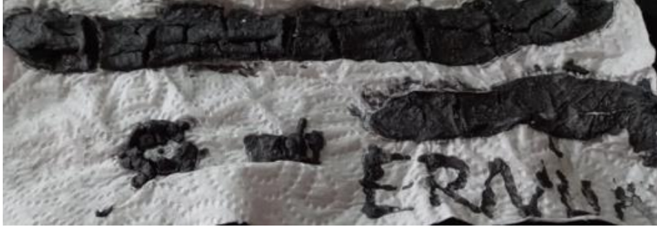
Şekil 4. 12. Grafit takviyeli numune ve baskı (grafit oranı %25).
