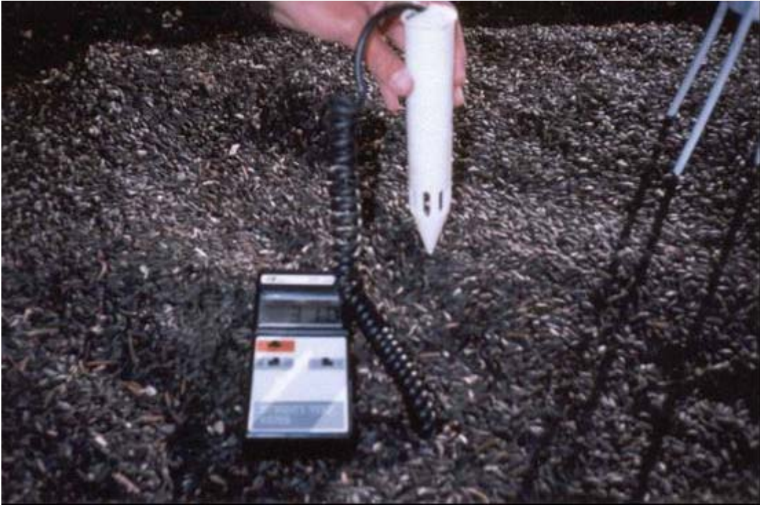
Şekil 3.10. Nem ve sıcaklık ölçer (Humidity / Temperaturemeter)
