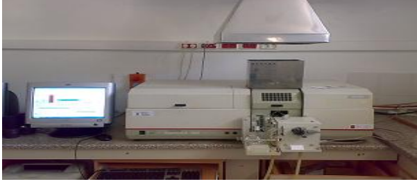
Resim 8. AAS Grafit Cihazı Spektra AA280Z
