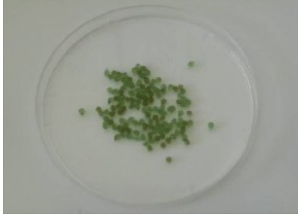
Şekil 4.2. Enginar PFO 'sunun alginat jelde tutuklanması ile elde edilen boncuklar (Damlatma çözeltisi % 2 'lik \text{CuCl}_2 )
