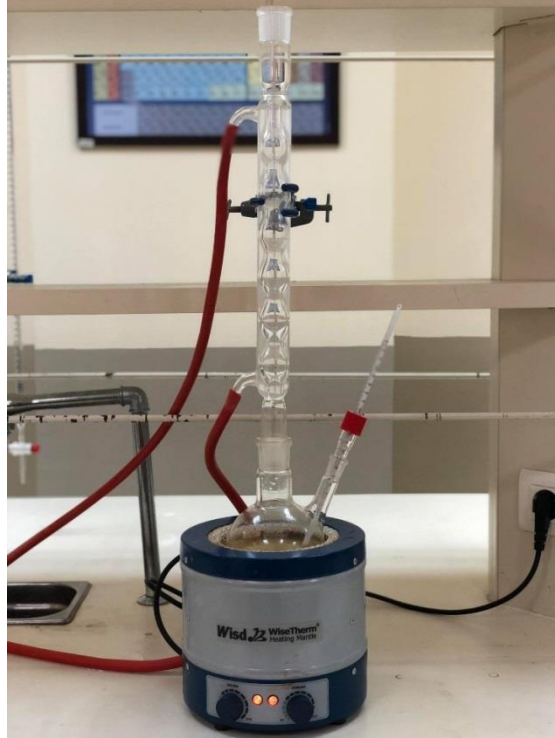
Şekil 3. 2. Asit yağın transesterifikasyonu için kurulan reflux düzeneği
