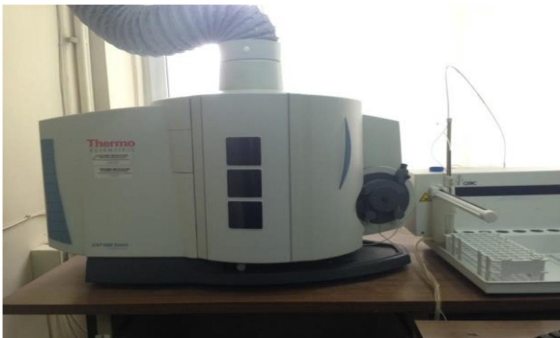
**Şekil 2. ICP-OES cihazı.**
