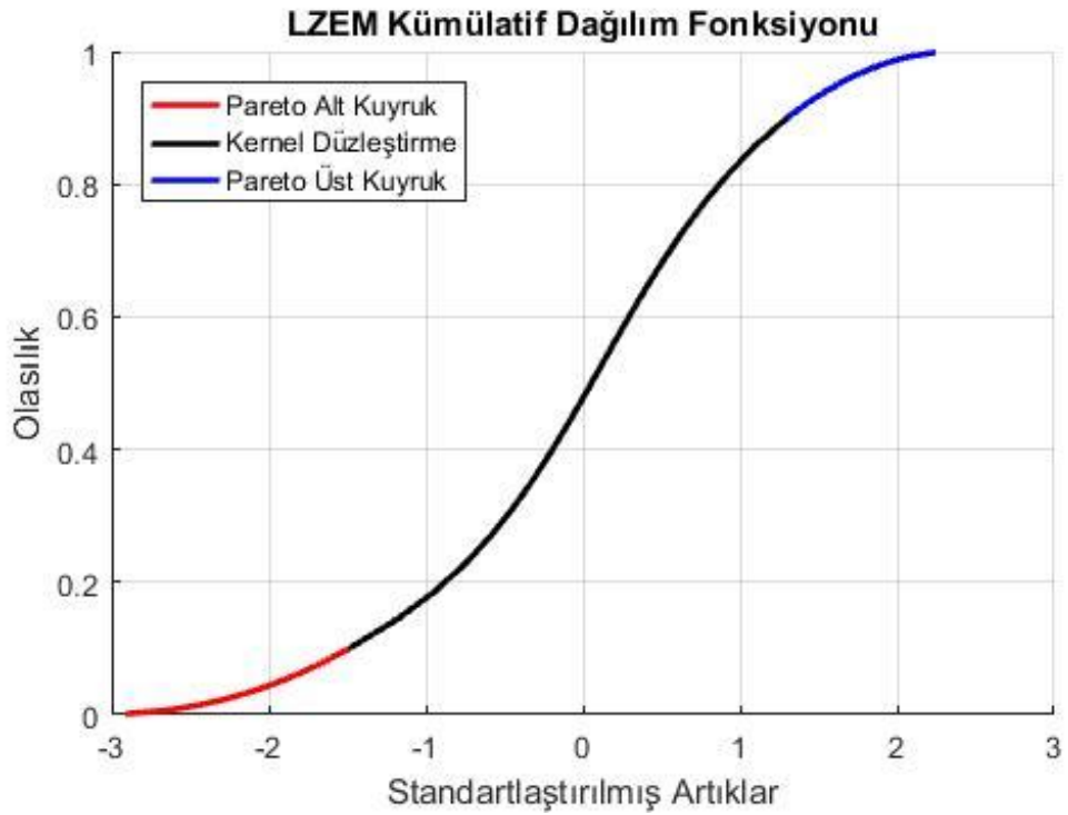
Şekil 60. SCHE Kümülatif Dağılım Fonksiyonu
