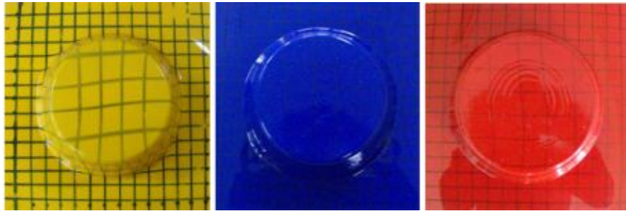
Şekil 3.1 Vakum ve ısı ile şekil verilen sırasıyla 2, 2.5 ve 3 mm kalınlığındaki PS konik yarı mamuller.
