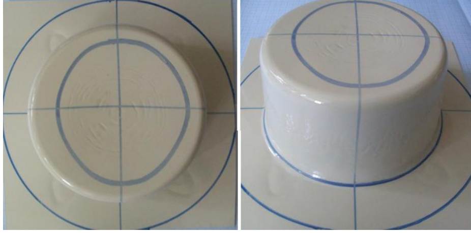
Şekil 3.77 Silindirik yarı mamul ve çember şekil değiştirme çizgilerinin perspektif görünüşü.
