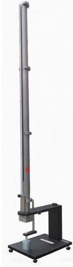
Şekil 3.71 Devotrans plastik darbe test cihazı SAH-YP
