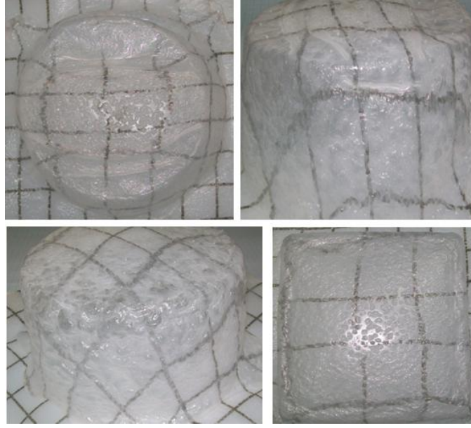
Şekil 3.72 Takviye elemanı içeren levhalarda vakum ve ısı ile şekil verme işlemi sonrasında oluşan üretim kusurları. (Katlanma, büzülme, aşırı deformasyon, yüzey pürüzlülüğü.
