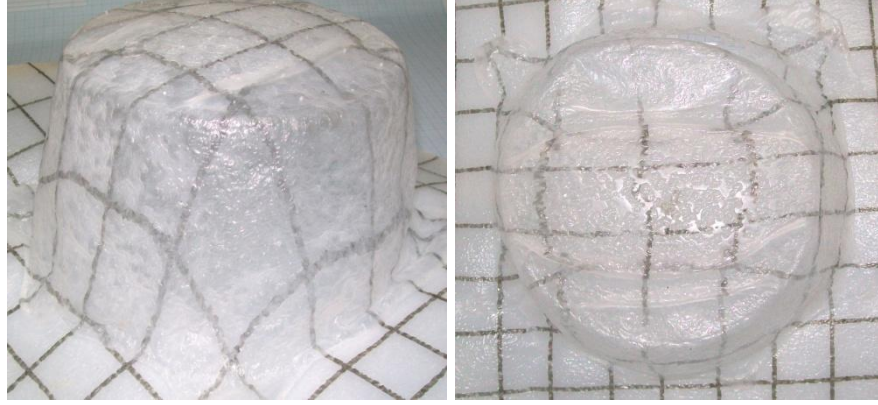
Şekil 3.40 Konik geometrili kalıpta şekil verilen % 5 cam elyaf takviyeli HDPE levha malzemenin farklı açılardan görünüşü.
