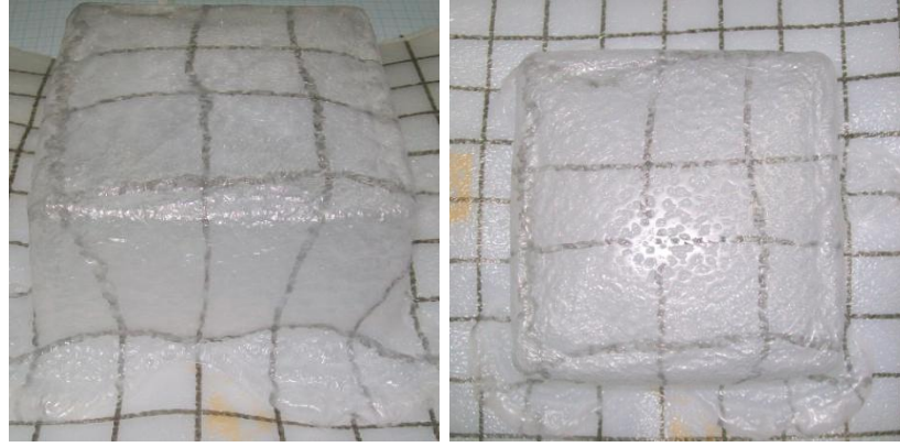
Şekil 3.41 Kübik geometrili kalıpta şekil verilen % 5 cam elyaf takviyeli HDPE levha malzemenin farklı açılardan görünüşü.
