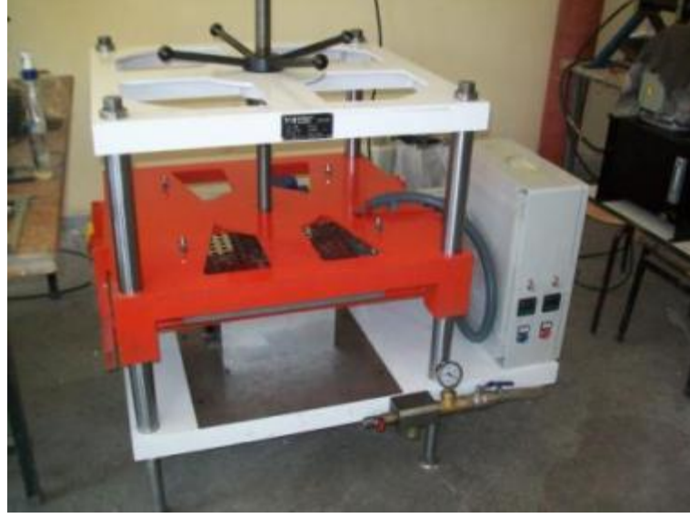
Şekil 2.8 Yeni yurt Makine A.Ş. tarafından üretilen laboratuvar tipi vakum ve ısı ile şekil verme ünitesi.
