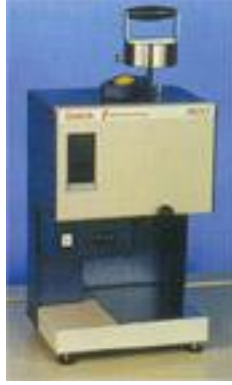
Şekil 3.70 Zwick 4100 Melt Flow Index akışkanlık ölçme cihazı.
