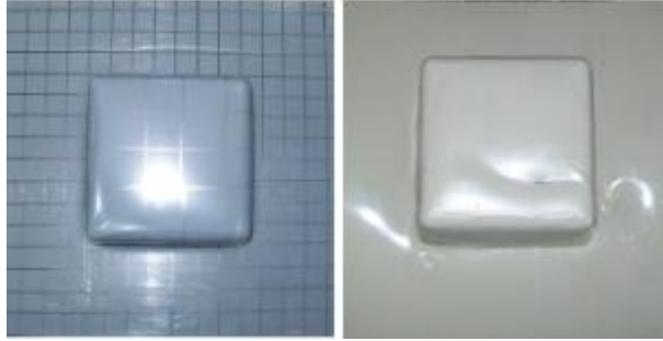
Şekil 3.4 Vakum ve ısı ile şekil verilen 3 mm kalınlığındaki sırasıyla PVC ve PP kübik yarı mamuller.
