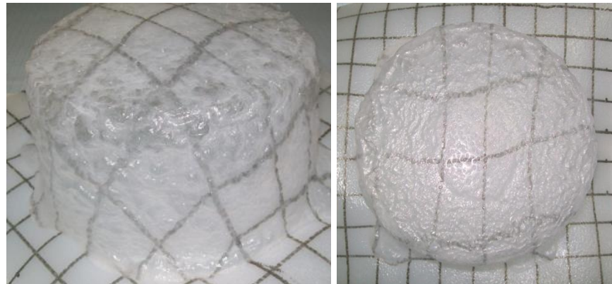
Şekil 3.42 Silindirik geometrili kalıpta şekil verilen % 5 cam elyaf takviyeli HDPE levha malzemenin farklı açılardan görünüşü.
