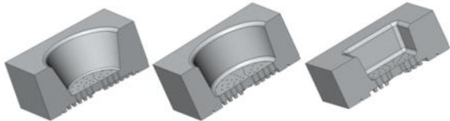
Şekil 2.25 Konik, silindirik ve kübik vakum ve ısı ile şekil verme kalıplarının tam kesit görünümü.
