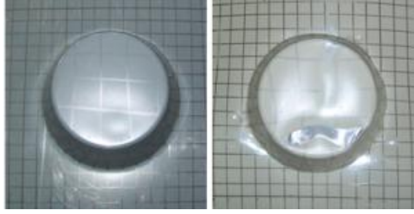
Şekil 3.5 Vakum ve ısı ile şekil verilen 3 mm kalınlığındaki sırasıyla PVC ve PP konik yarı mamuller.
