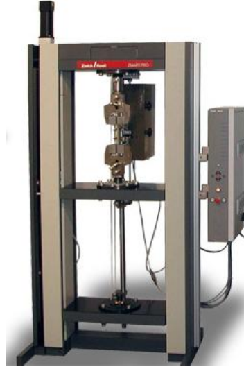
Şekil 3.67 Deneylerde kullanılan Zwick-Roell Type 1455-20 kN (Materials Testing Machine, Floor-Standing Model) çekme deney cihazı
