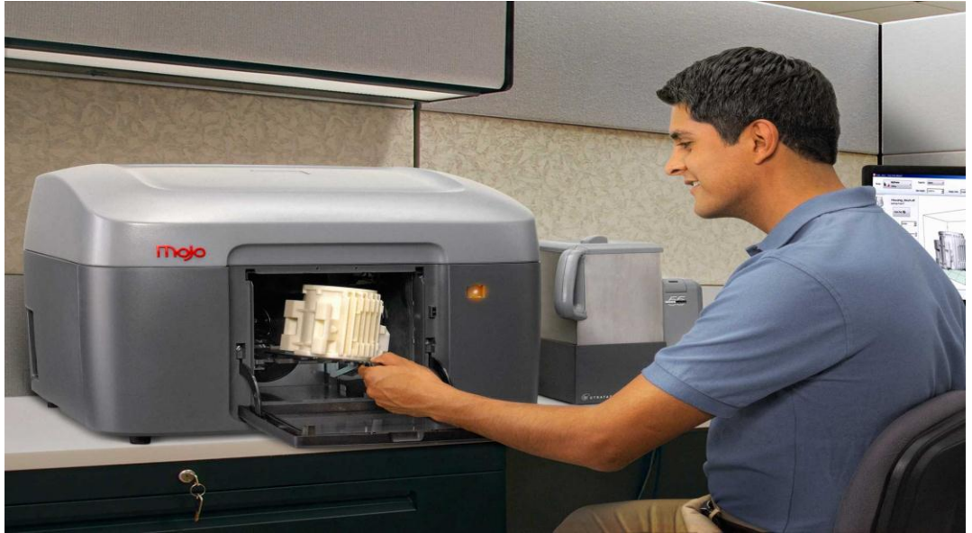
Şekil 2.3. Bir motorun dış kasasının 3D yazıcıdan elde edilişi
