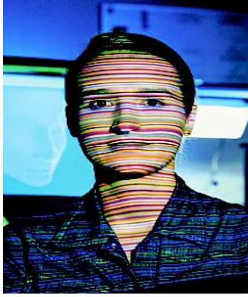
Şekil 3.11. Şerit indekslenmiş desenin modellenecek kişi üzerine yansıtılması
