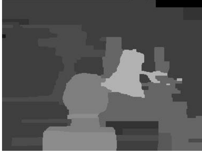
Şekil 2.34. Stereo analiz sistemiyle elde edilen derinlik haritası.
