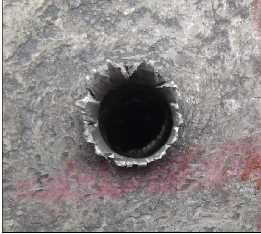
Şekil 6.13. %10 SiC Takviyeli Numune Atış Sonrası Giriş Deliği
