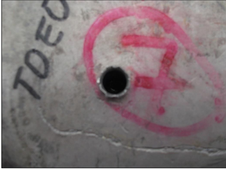
Şekil 6.3. Takviyesiz Numune Atış Sonrası Giriş Deliği
