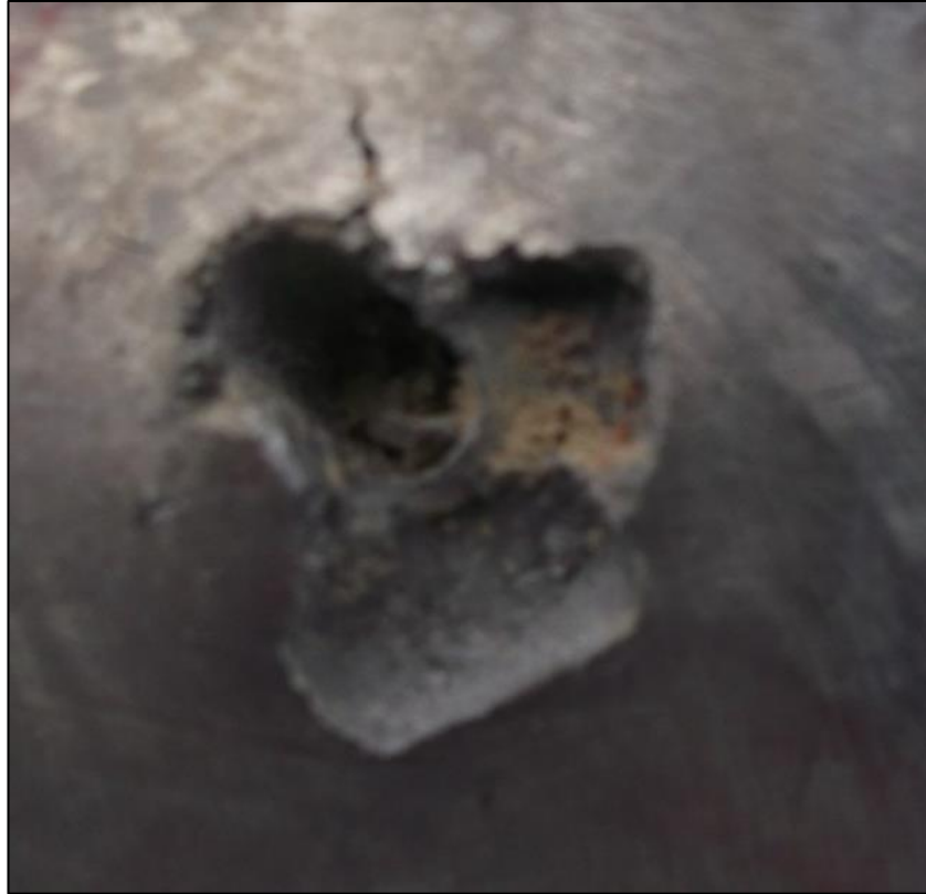
Şekil 6.24. %20 SiC Takviyeli Numune Atış Sonrası Çıkış Deliği
