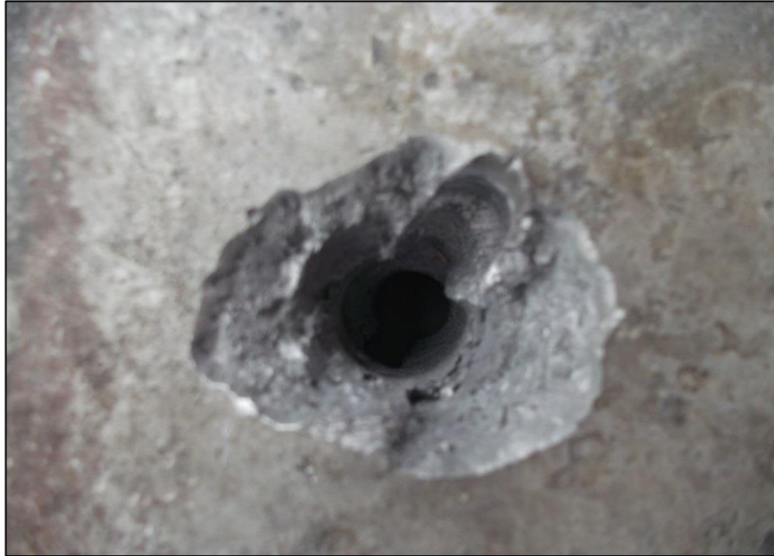
Şekil 6.34. %30 SiC Takviyeli Numune Atış Sonrası Çıkış Deliği
