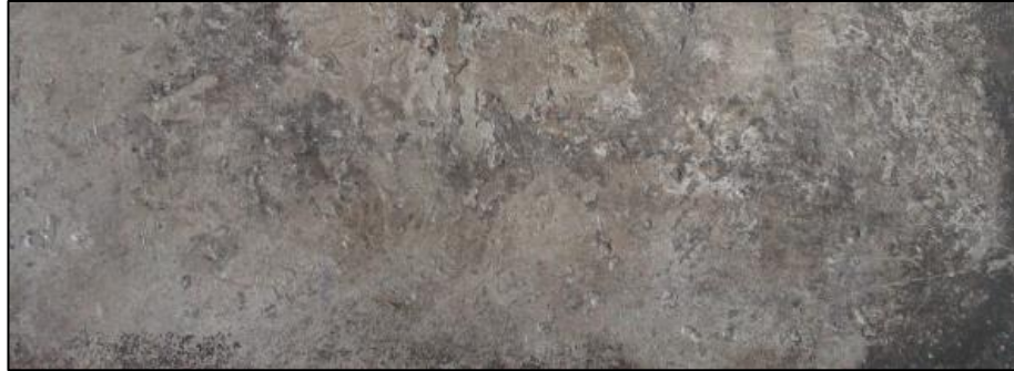
Şekil 6.32. %30 SiC Takviyeli Numune Atış Öncesi Kesiti
