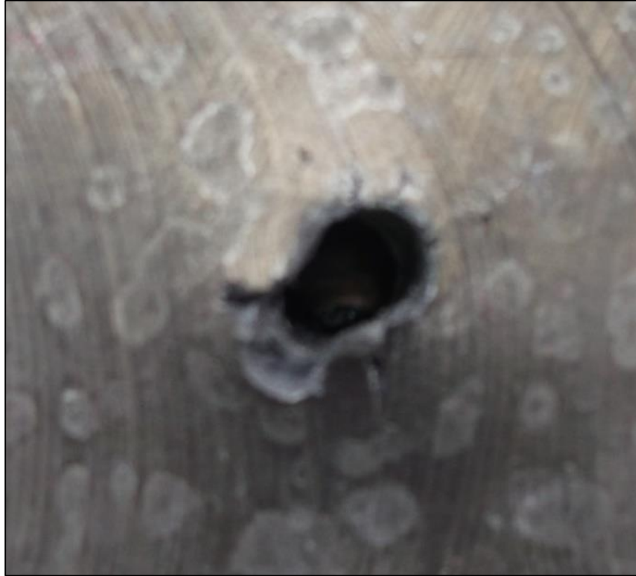
Şekil 6.4. Takviyesiz Numune Atış Sonrası Çıkış Deliği
