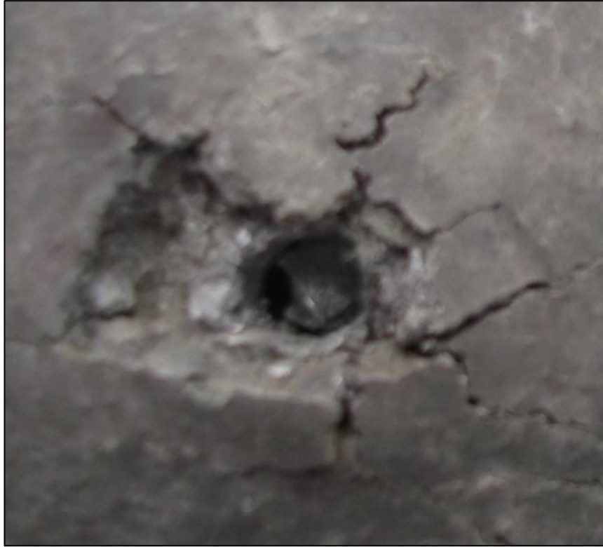
Şekil 6.29. %25 SiC Takviyeli Numune Atış Sonrası Çıkış Deliği
