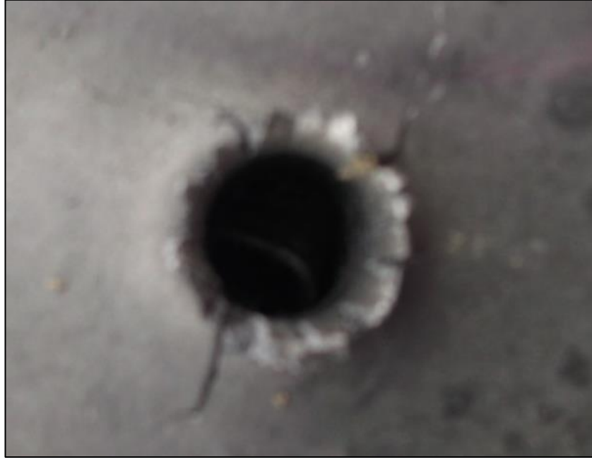
Şekil 6.23. %20 SiC Takviyeli Numune Atış Sonrası Giriş Deliği
