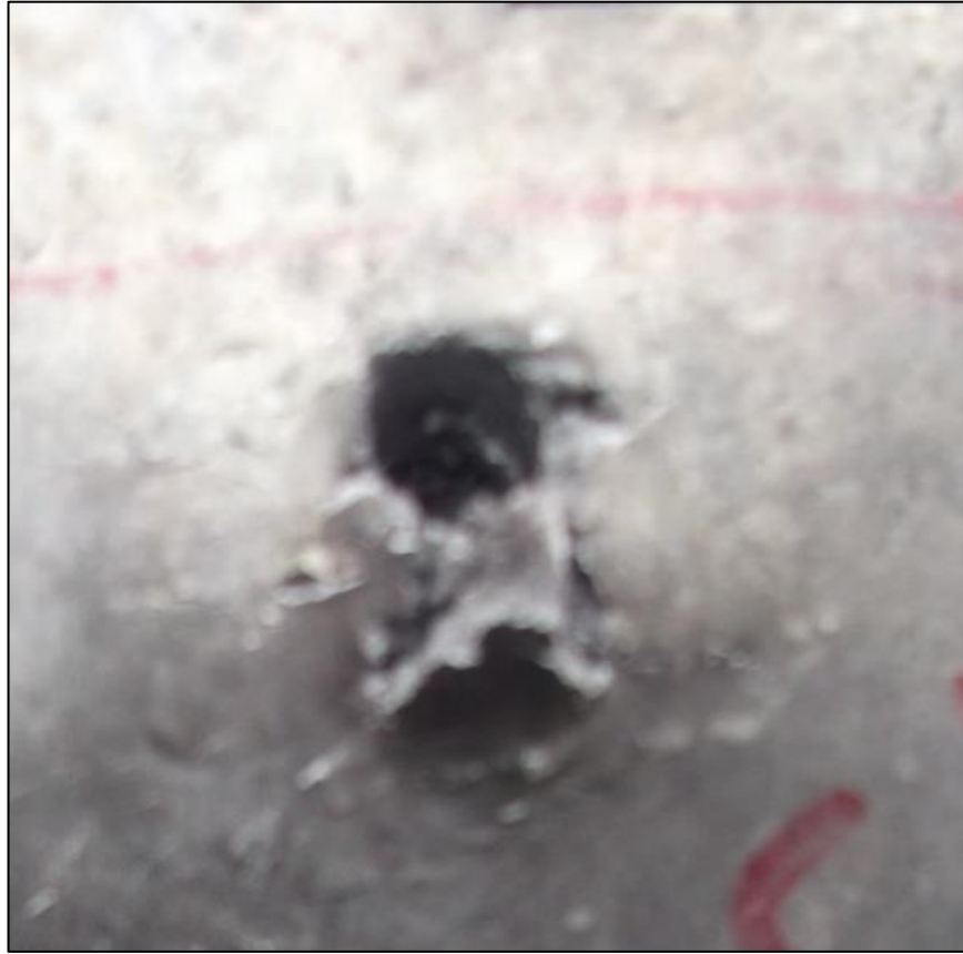
Şekil 6.19. %15 SiC Takviyeli Numune Atış Sonrası Çıkış Deliği
