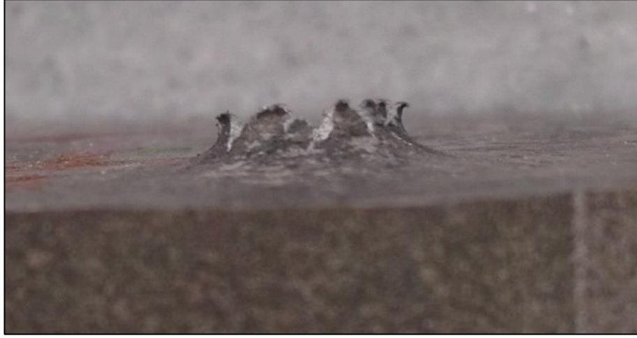
Şekil 6.15. %10 SiC Takviyeli Numune Atış Sonrası Giriş Deliği Yandan Görünümü
