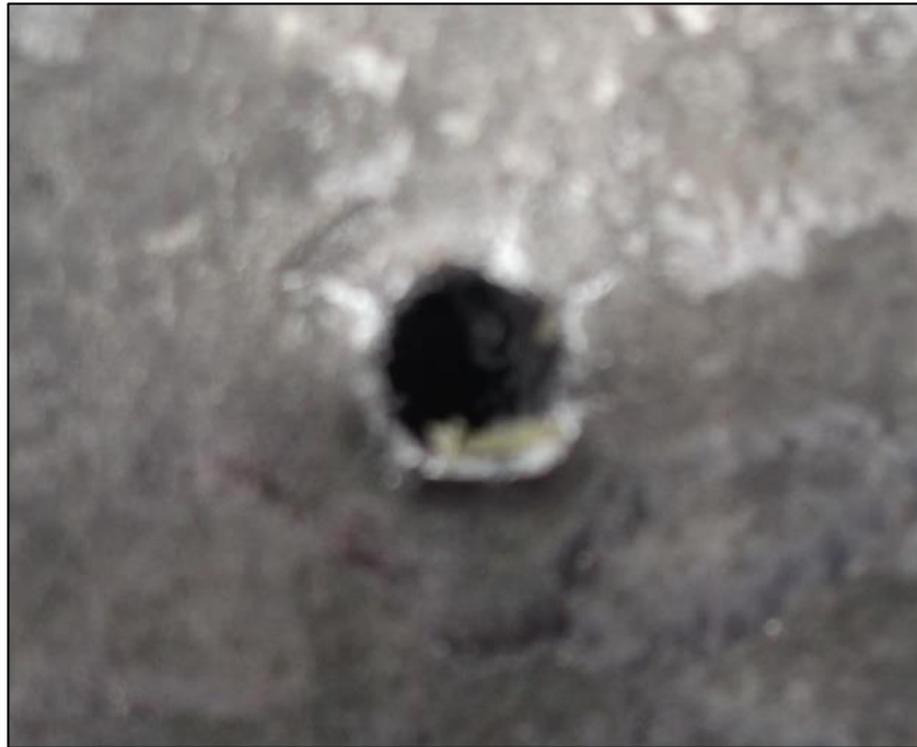
Şekil 6.9. %5 SiC Takviyeli Numune Atış Sonrası Çıkış Deliği
