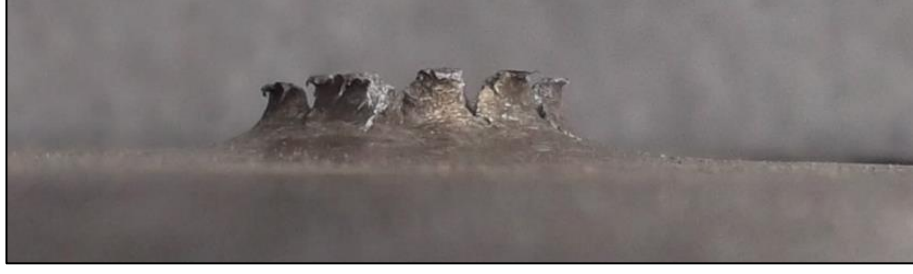
Şekil 6.20. %15 SiC Takviyeli Numune Atış Sonrası Giriş Deliği Yandan Görünümü
