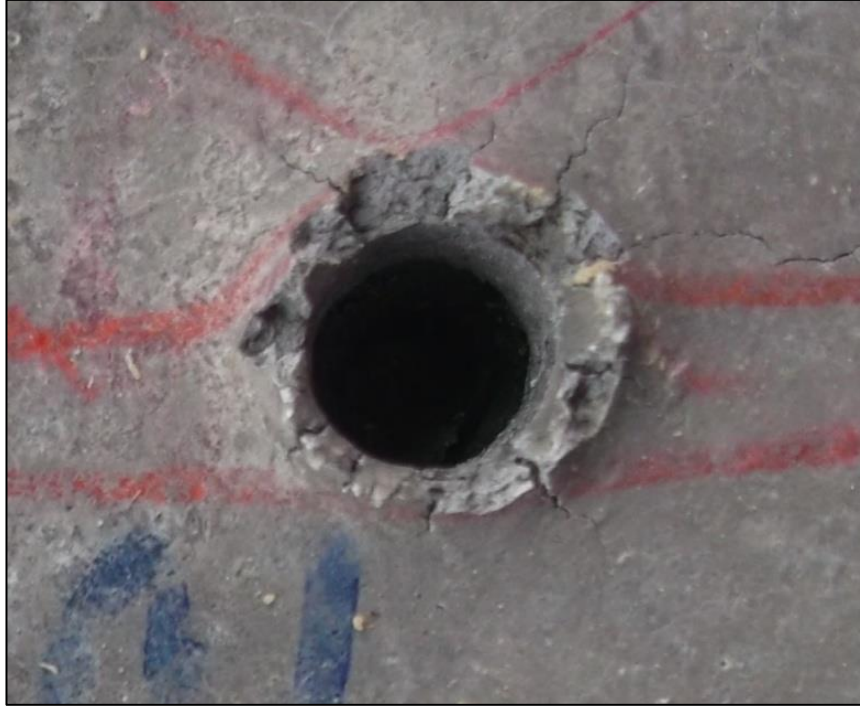
Şekil 6.28. %25 SiC Takviyeli Numune Atış Sonrası Giriş Deliği
