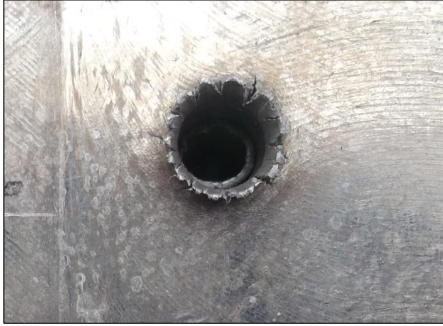
Şekil 6.18. %15 SiC Takviyeli Numune Atış Sonrası Giriş Deliği
