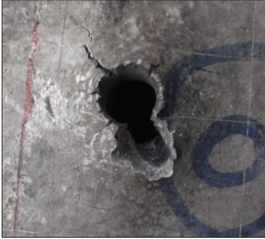
Şekil 6.33. %30 SiC Takviyeli Numune Atış Sonrası Giriş Deliği
