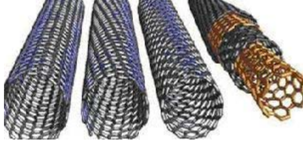
Şekil 2.4. Tek duvarlı ve çok duvarlı karbon nanotüpler
