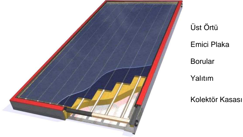
Şekil 3.1. Düzlemsel güneş toplayıcıları ve kısımları
