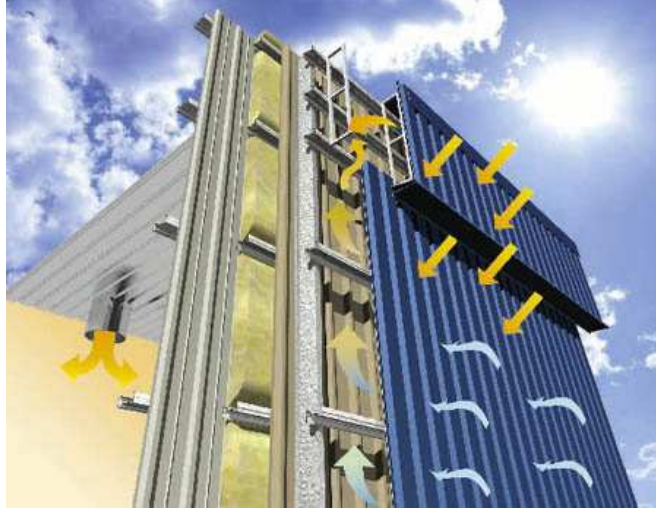
Şekil 4.15. Havalı güneş toplayıcısı (Solarwall, 2001/2006)
