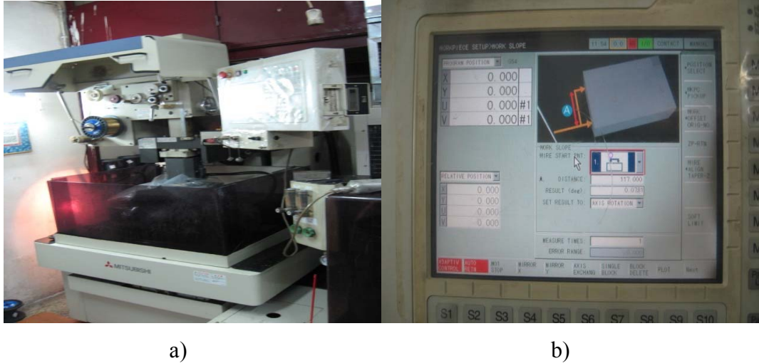
Şekil 6.5 Çentik darbe numunelerinin hazırlandığı Mitsubishi RA-90 EDM tezgahı
