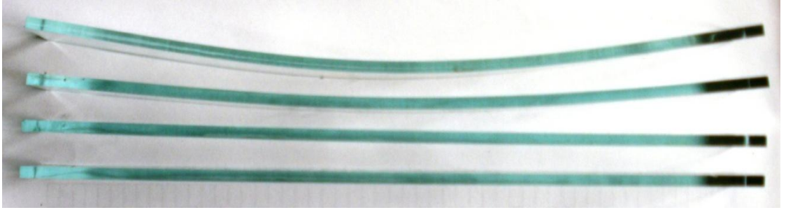
Şekil 4.1. Tipik şekil değiştirmiş ve değiştirmemiş cam şeritler
