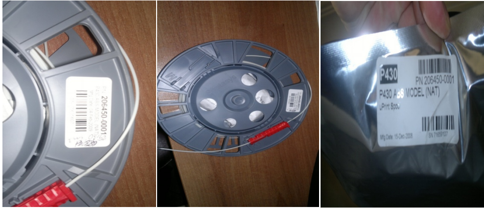
Şekil 4.2 Hızlı prototipleme cihazına ait ABS P 430 (NAT) malzeme tamburu
