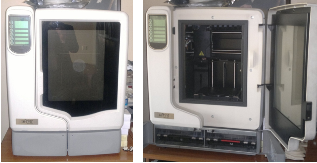
Şekil 4.3. Sıvama yöntemi kullanan hızlı prototipleme cihazı
