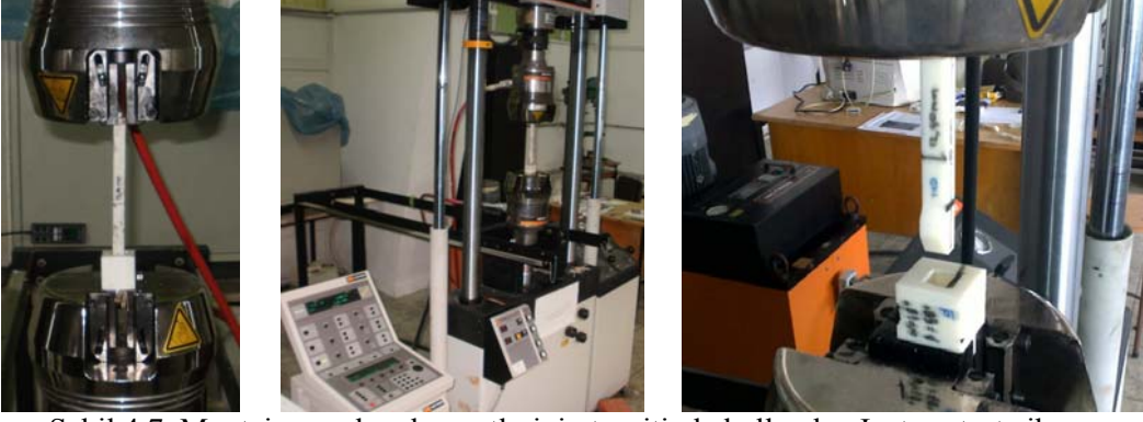
Şekil 4.7. Montaj – ayrılma kuvvetlerinin tespitinde kullanılan Instron test cihazı
