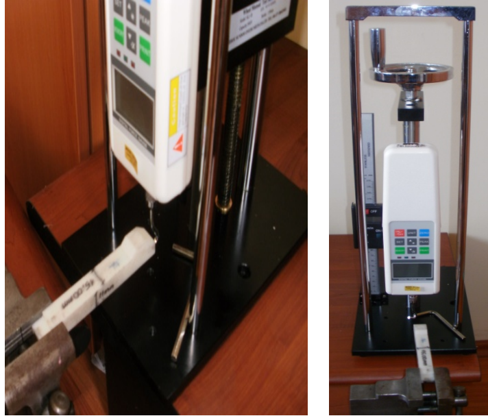
Şekil 4.6. Deneysel atalet momentinin bulunması için kurulan deney düzeneği
