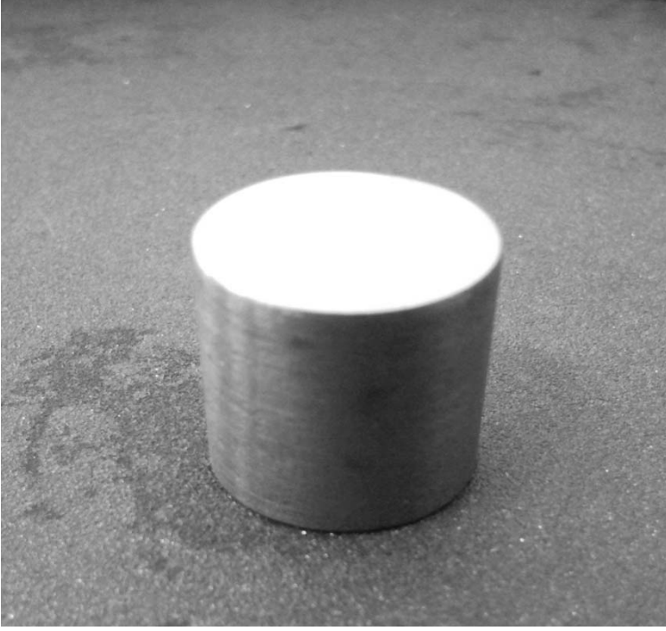
Şekil 6.22. Yüzey işlemlerini bitmiş test numunesi
