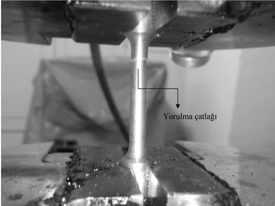
Şekil 6.21. Bir yorulma deneyi sonucu numunenin görünüşü
