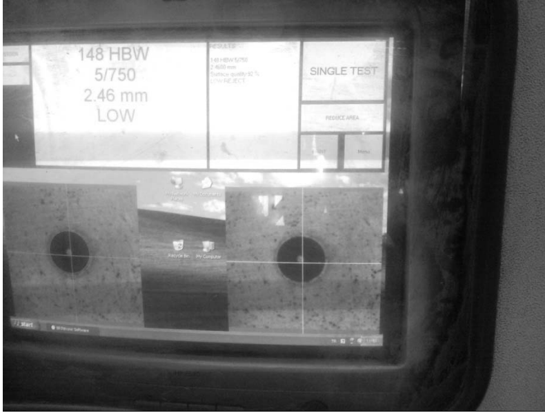
Şekil 6.24. Bir sertlik testi anında bilgisayar kontrolü
