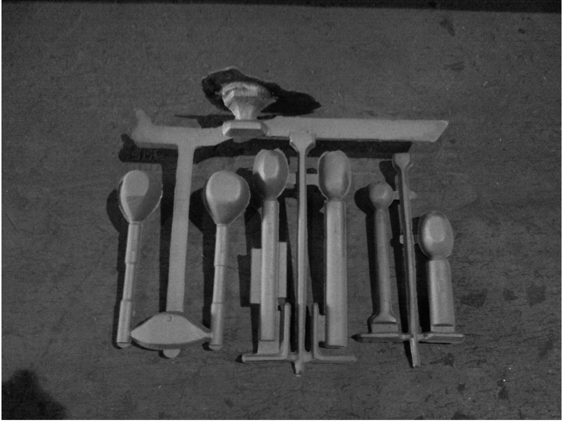
Şekil 6.14. Döküm hattından çıkan parçanın nihai görünüşü
