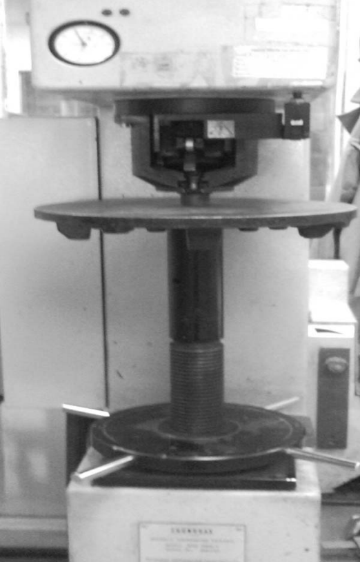
Şekil 6.23. Numune yerleştirilmiş sertlik cihazı görüntüsü
