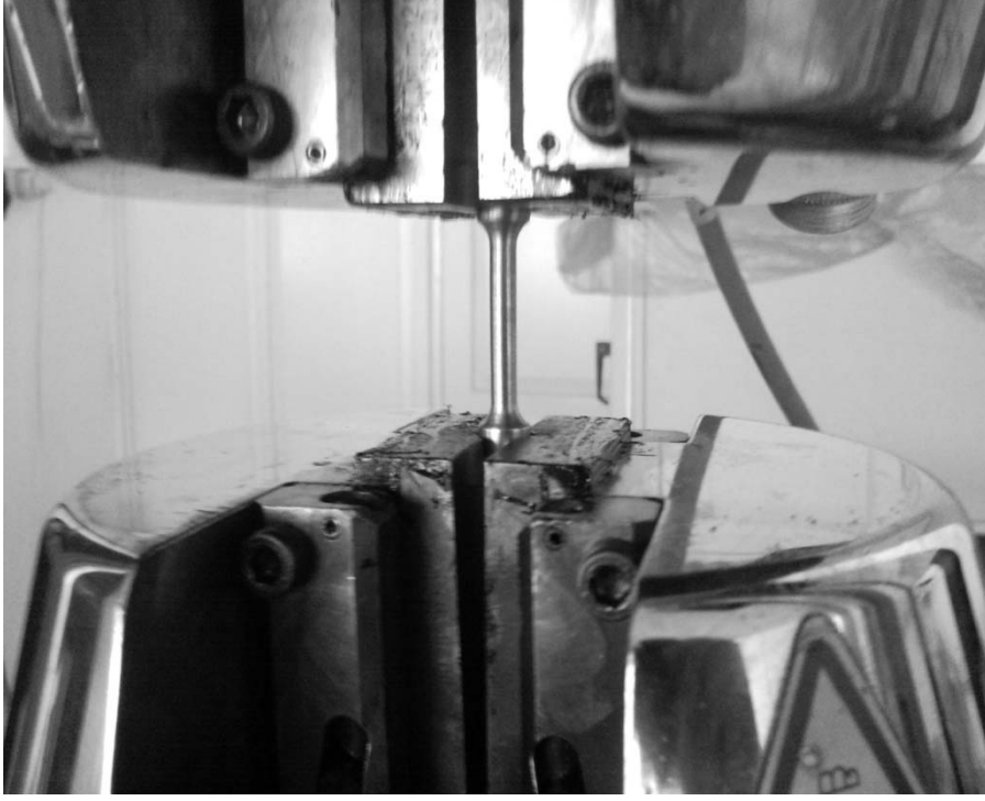
Şekil 6.19. Alt ve üst çene arasına yerleştirilmiş çekme çubuğu
